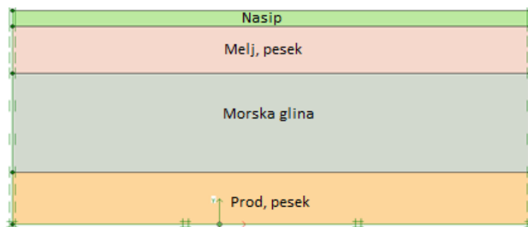
Slika 33: Karakteristični prečni prerez tal v območju obale
