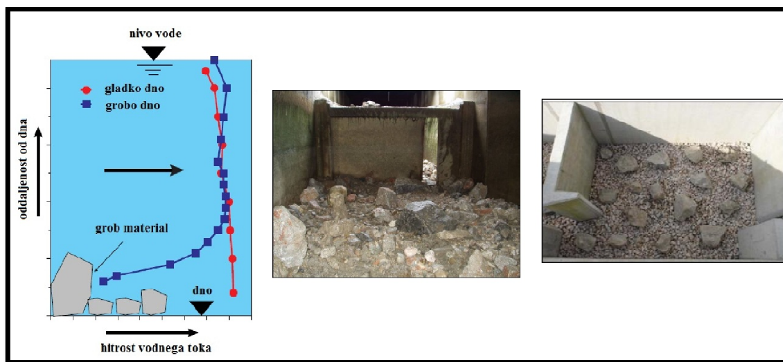
Slika 7: Hrapavo dno ribjega prehoda z grobimi frakcijami na finejši podlagi (Vir: DVWK 2002, AG-FAH 2011)
