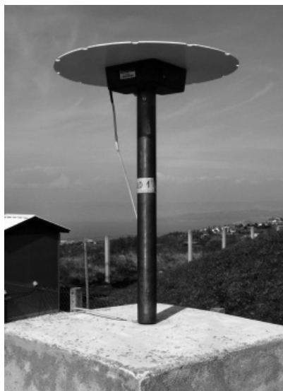
Slika 6: Prilno centriranje antene GNSS na točki na objektu
