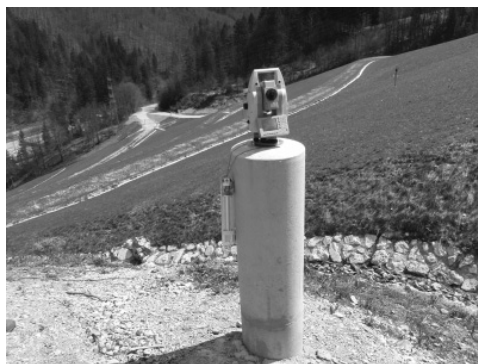
Slika 2: Referenčna točka za izmero GNSS in terestrično izmero
