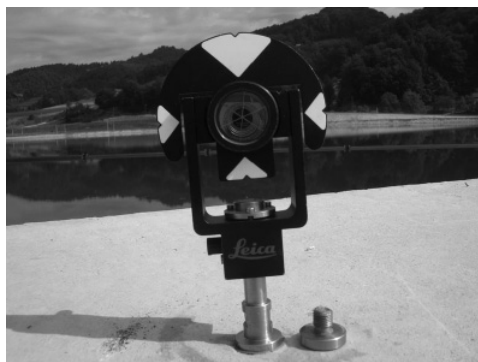
Slika 4: Talna stabilizacija točke na objektu s klinom za terestrično izmero
