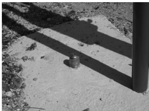
Slika 3: Stabilizacija talnega reperja z možnostjo postavitve stativa
