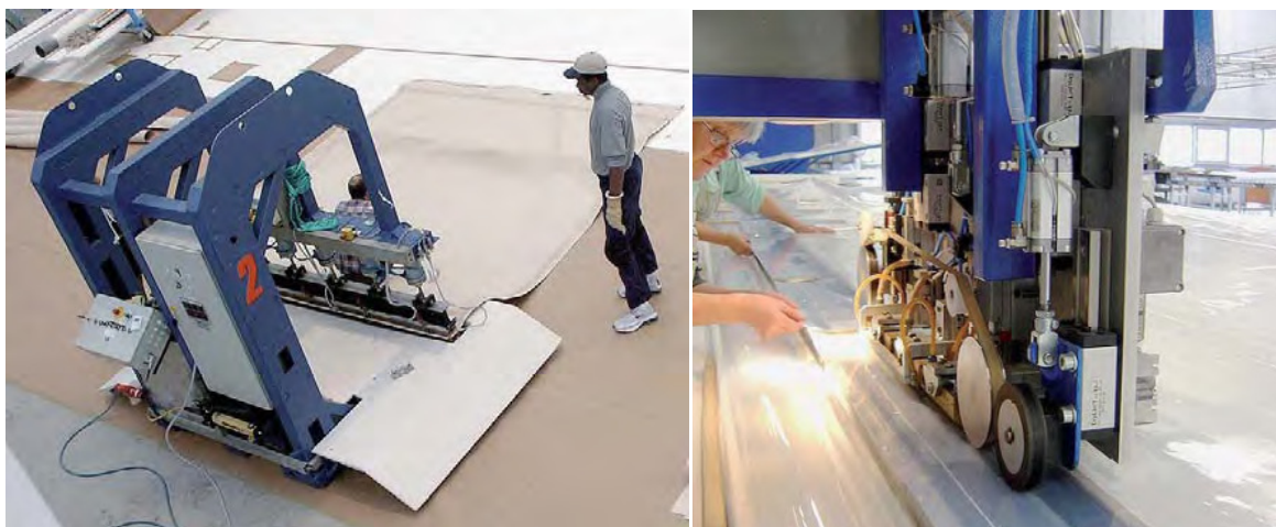
Slika 77: Levo: Varjenje FG/PTFE membran; Desno: Varjenje ETFE folij (Seidel, 2009)
