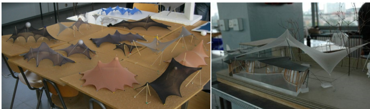
Slika 50: Levo: Fizični modeli prednapetih membranskih konstrukcij iz najlona, ki so jih izdelali udeleženci konference Textile Roofs 2011 v Berlinu; Desno: Natančen fizični model iz najlona
