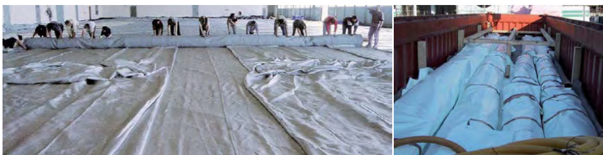
Slika 80: Levo: Zvijanje končane membrane v delavnici; Desno: Zvite membrane v transportnem zaboju (Seidel, 2009)
