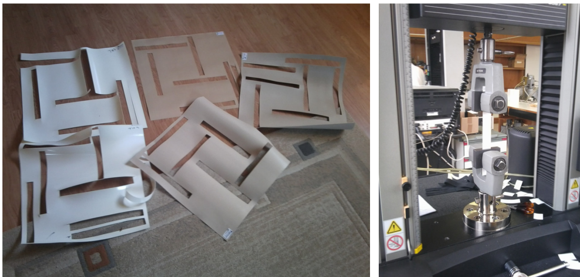
Slika 45: Levo: Vzorci različnih membran z izrezanimi tračnimi preizkušanci; Desno: Aparat za natezno preizkušanje v laboratoriju Oddelka za tekstilstvo, NTF
