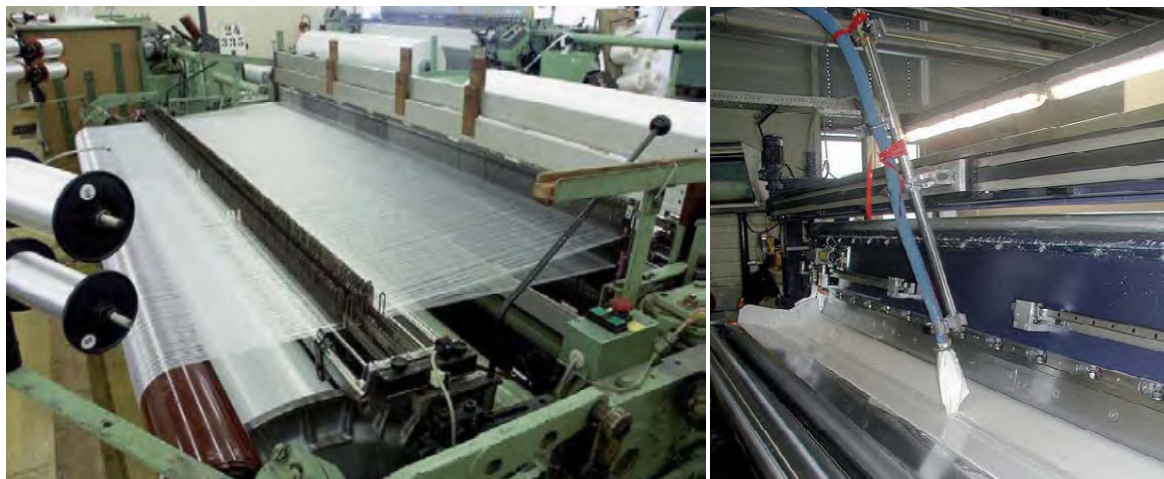
Slika 32: Levo: Avtomatske statve; Desno: Nanašanje PVC matrice z zračnim nožem (Seidel, 2009)
