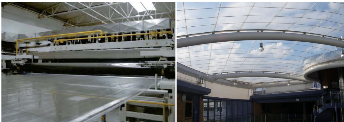
Slika 36: Levo: Proizvodnja ETFE folije z ekstruzijo skozi ploščato režo (Seidel, 2009); Desno: Primer enoslojne ETFE membranske konstrukcije ojačane s kabli (ETFE foil, 2011)
