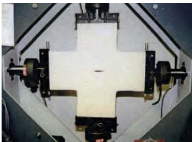
Slika 54: Test odpornosti na širjenje raztrganin v dvoosnem nateznem aparatu (Seidel, 2009)
