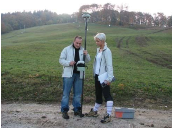
Slika 15: RTK – metoda izmere
