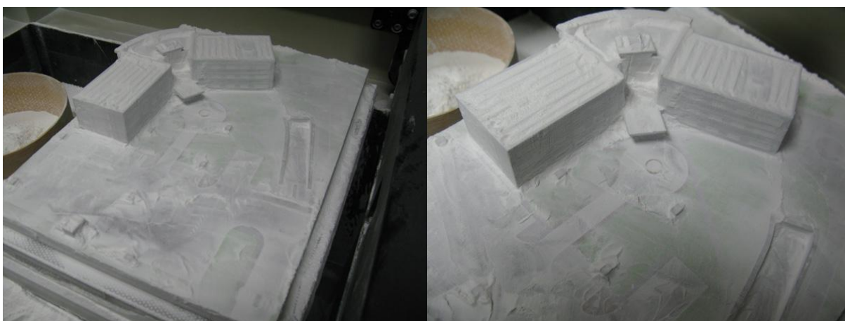
Slika 41: Izvedena maketa po odstranitvi večjega dela odvečnega prahu (pred temeljitejšim čiščenjem makete z integriranim pihalnikom zraka)
