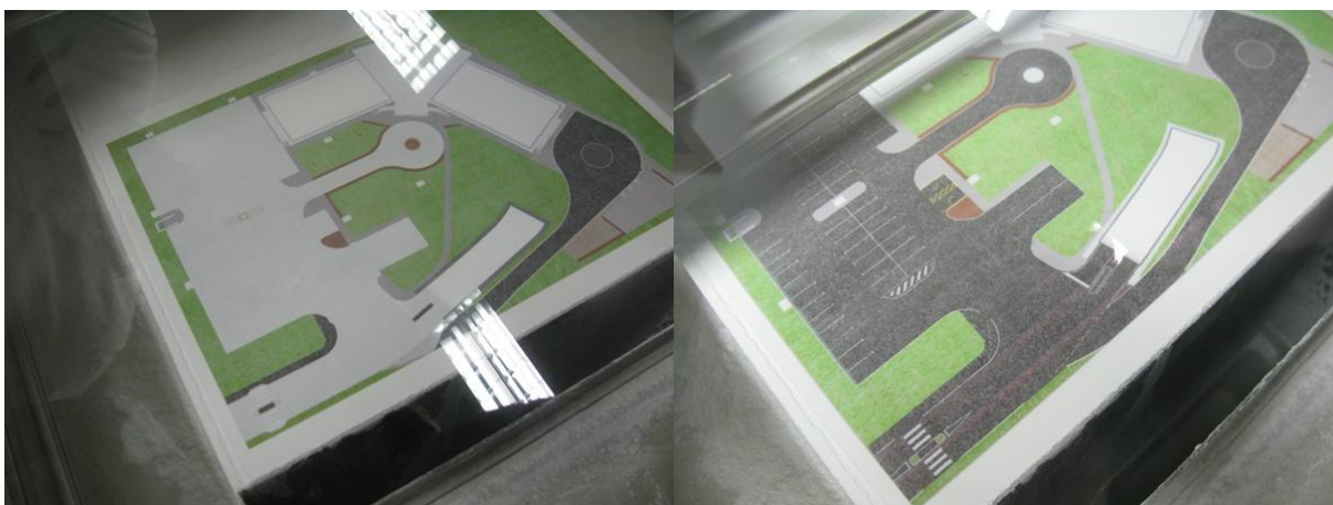
Slika 40: Pogled na nastajajočo maketo med samo izvedbo 3D tiska – prikazani sta vmesni stanji izvedbe različnih plasti modela (dobro je vidna zunanja ureditev objekta, medtem ko se sam objekt še ni začel “dvigovati”)
