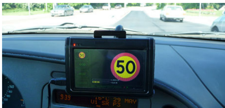
Grafični prikaz sistema elektronske prilagoditve hitrosti ( www.international.stockholm.se/.../TK_ISA_460.jpg )
