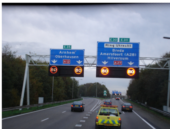
Slika 23: Prikaz znaka s spremenljivo vsebino – VMS
