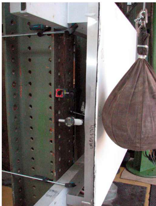
Slika 25: udarec z mehkim telesom - mehka vreča mase 50 kg
