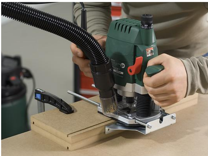
Slika 7: Rezkalni stroj primeren za rezkanje Kerrocka
