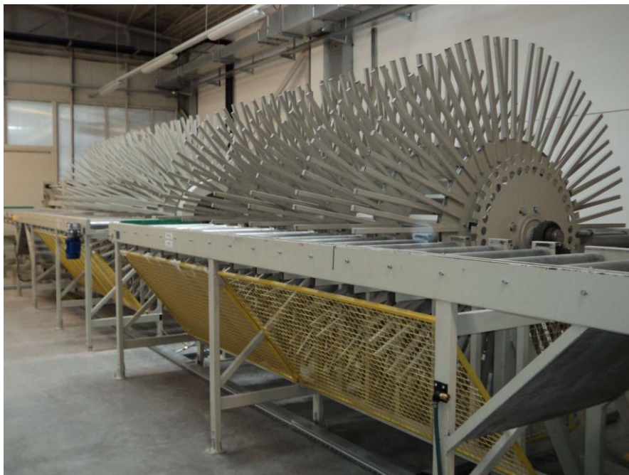
Slika 4: Rotor za hlajenje Kerrock plošč (foto: Mihelič 2011)
