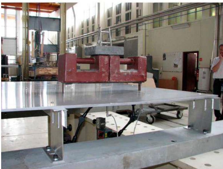
Slika 22: Obremenitev izvedena na sredini med obema podporama podkonstrukcije (med levo in desno konzolo)
