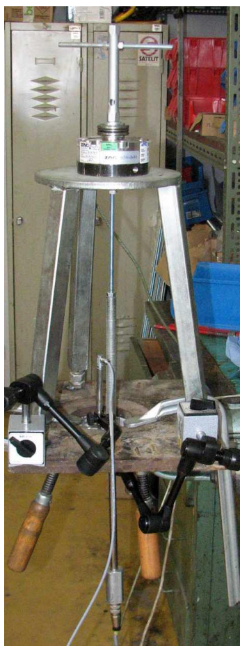
Slika 28: Dajalnik sile s katerim je bila preskušena objemka
