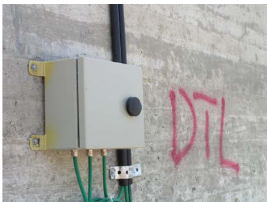
Slika 5.1: Data logger - zajemna enota podatkov sidrnih sil
