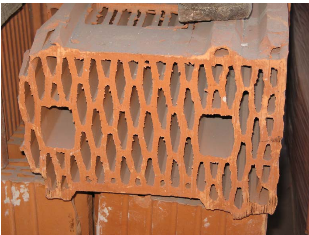
Slika 3.6: Opečni nosilni zidak, ki služi hkrati kot toplotna izolacija
