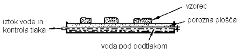
Slika 10: Vakuumska plošča – naprava, ki meri sukucijo s pomočjo podtlaka (Marshall in Holmes, 1988).
