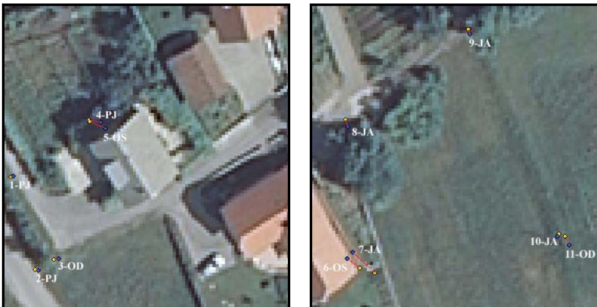
Slika 25: Primerjava vektoriziranih objektov (modro) in objektov, merjenih na terenu (rumeno)
