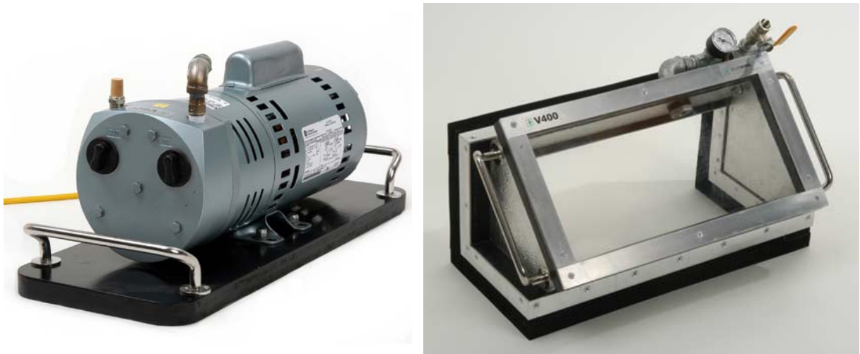
Slika 13: Vakuumska črpalka ter vakuumski poveznik za kotne zware
