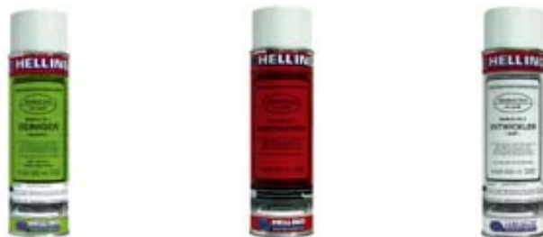
Slika 11: Komplet za penetrantsko kontrolo (čistilo, penetrant in razvijalec)
