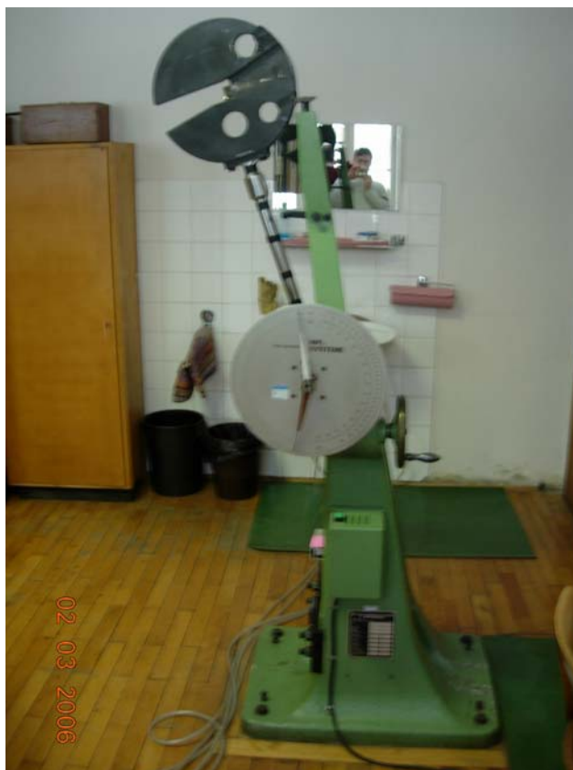
Slika 19: Inštrumentirano Charpy-jevo kladivo za merjenje udarne žilavosti na Inštitutu za kovinske materiale in tehnologije v Ljubljani
