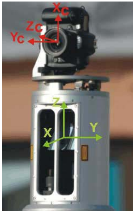
Slika 3: Koordinatni sistem skenerja in fotoaparata (Riegl laser measurement systems – spletna stran, 15.09.2005)
