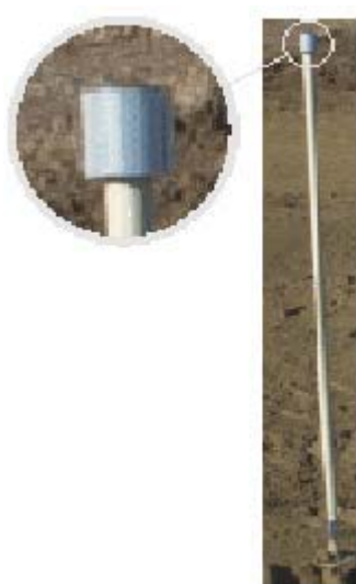
Slika 10: Refleksijska cilindrična tarča (Riegl laser measurement systems – spletna stran, 15.09.2005)
