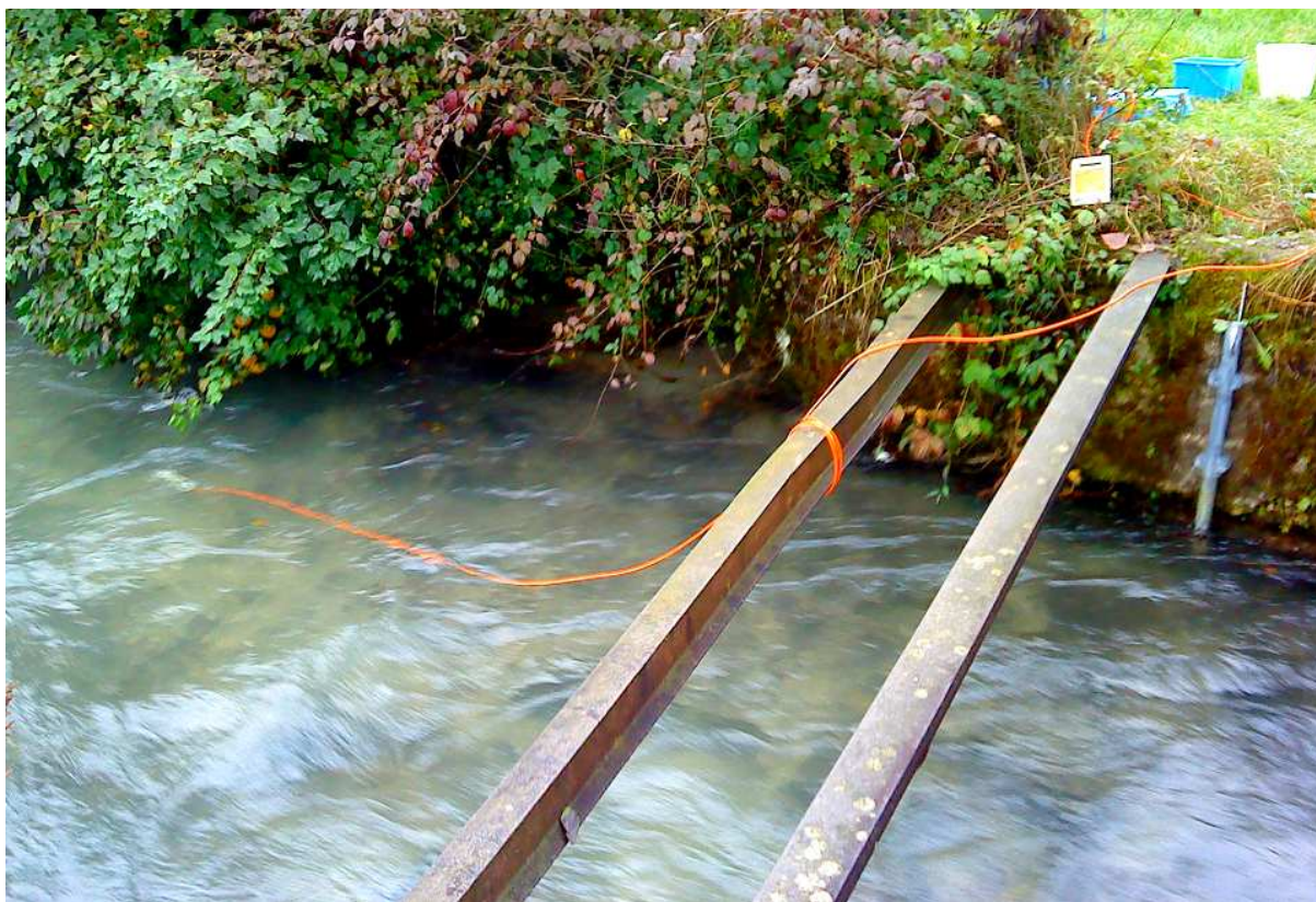
Slika 33: Postavitev sonde pri metodi razredčenja
