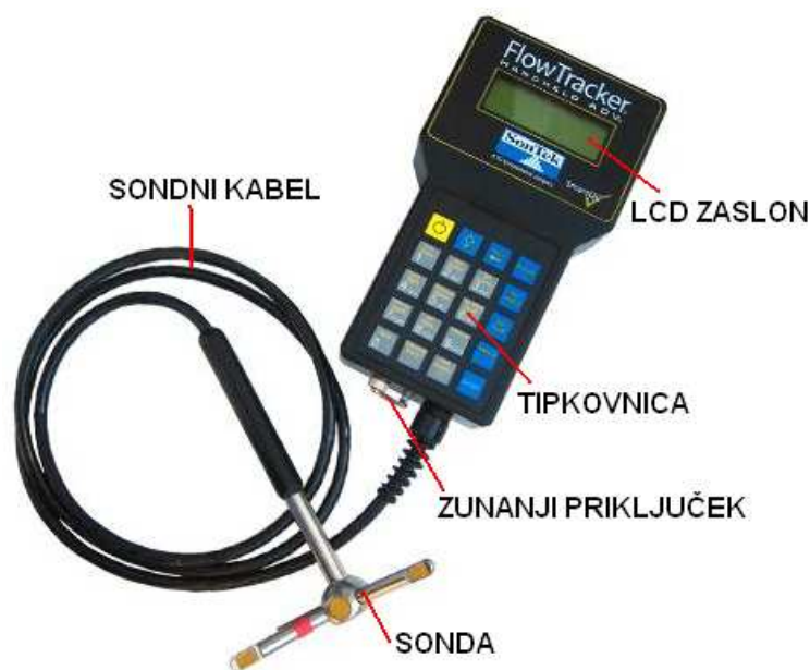
Slika 12: Merilec pretočnih hitrosti FlowTracker ( www.sontek.com )
