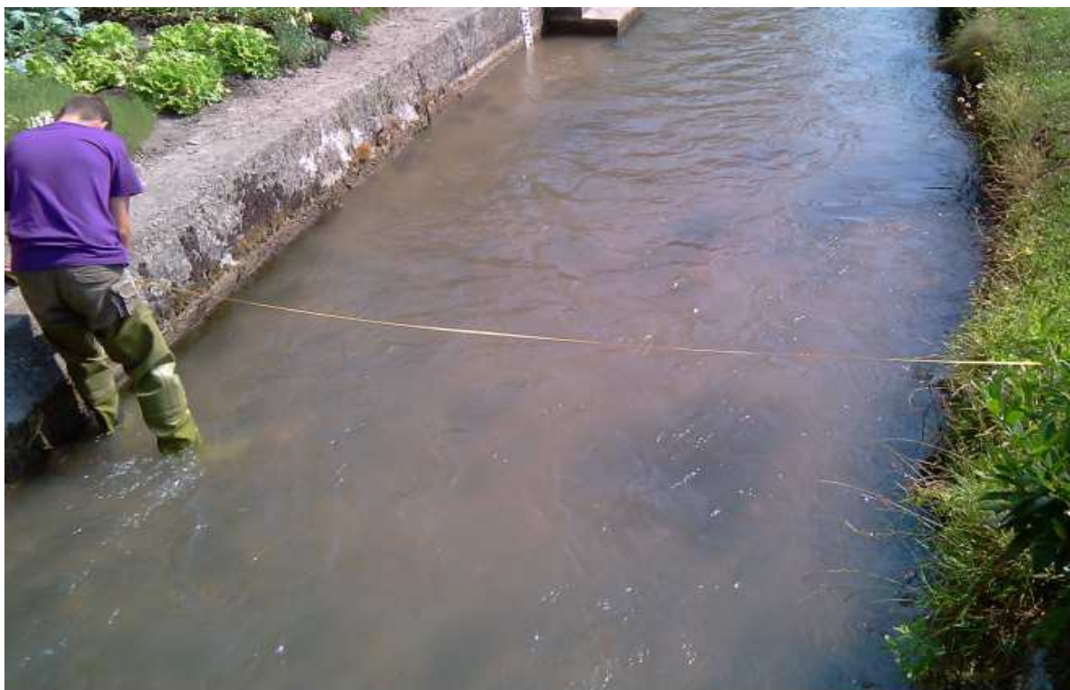
Slika 29 : Postavitev merskega traka
