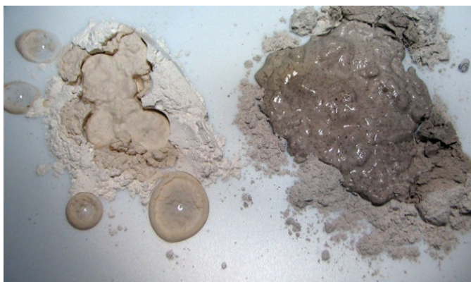
Preprost test hidrofilitnosti apnenčevih mok L in C (Duh, Žarnič, Bokan-Bosiljkov, 2006).
