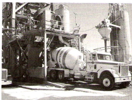
Centralno mešan beton v betonarni (Kumar Mehta, Monteiro, 2006).
