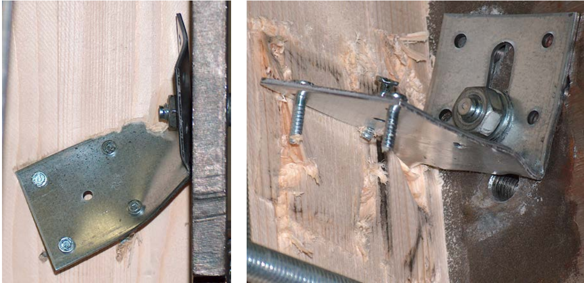
Sliki 27 in 28: Panel RIKO s BMF kotnim sidrom in 40mm žablji pri prečni preiskavi, levo deformiranje sidra med preiskavo, desno porušitev žabljev med preiskavo
