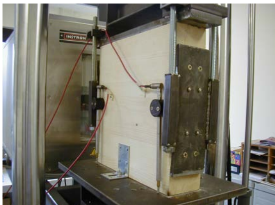
Sliki 34 in 35: RIKO panel in BMF sidro z žebli dolžine 40 mm, levo pred preiskavo, desno ena izmed porušitev – razkol panela vzdolž lesenih vlaken.
