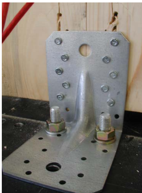
Sliki 25 in 26: KLH panel s kotnimi sidri BMF in žebli dolžine 60 mm, levo deformacija lesa in desno razkol lesa po vlaknih.
