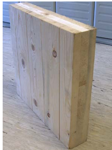
Sliki 3 in 4: Panel KLH - levo v pogledu in desno aksonometričen pogled.
