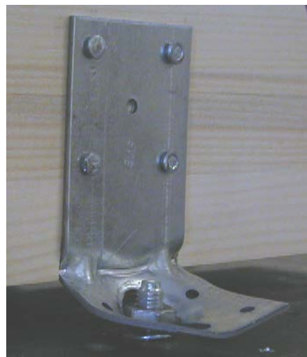
Sliki 19 in 20: RIKO panel s kotnim sidrom BMF 6191 in žablji dolžine 40 mm, levo porušitev lesa, desno zdrs sidernega vijaka skozi utor v sidru.
