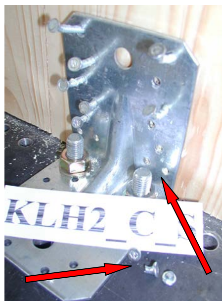
Sliki 42 in 43: KLH panel in BMF sidro z žebli dolžine 60 mm po ciklični preiskavi, levo izvlek žebeljev in iztrg lesa po vlaknih, desno strižna porušitev žebeljev.
