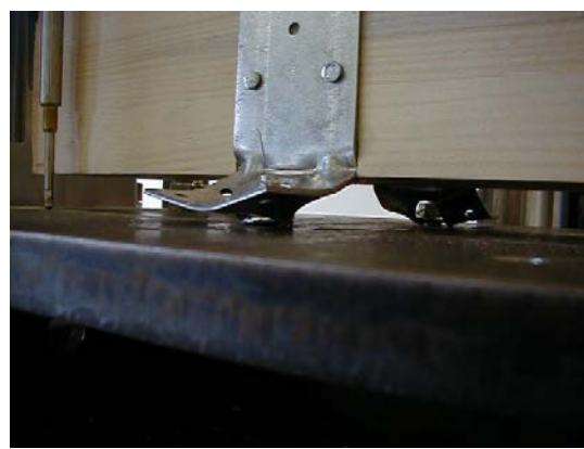
Sliki 36 in 37: RIKO panel in BMF sidro z žebli dolžine 40 mm, levo porušitev panela vzdolž vlaken in desno značilna deformacija kotnega sidra po ciklični preiskavi.
