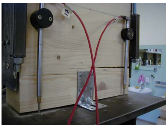
Sliki 36 in 37: RIKO panel in BMF sidro z žebli dolžine 40 mm, levo porušitev panela vzdolž vlaken in desno značilna deformacija kotnega sidra po ciklični preiskavi.
