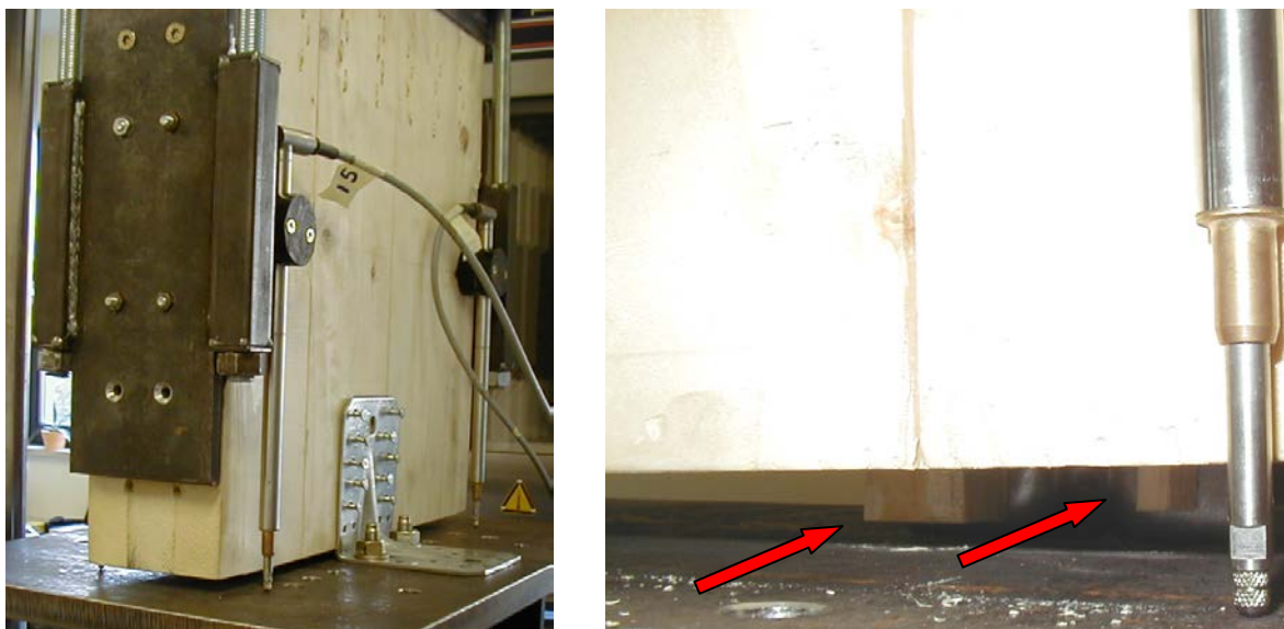
Sliki 23 in 24: KLH panel s kotnimi sidri BMF in žablji dolžine 40 mm, levo izvlek žabljev med preiskavo in desno iztrganje lesa pa vlaknih.
