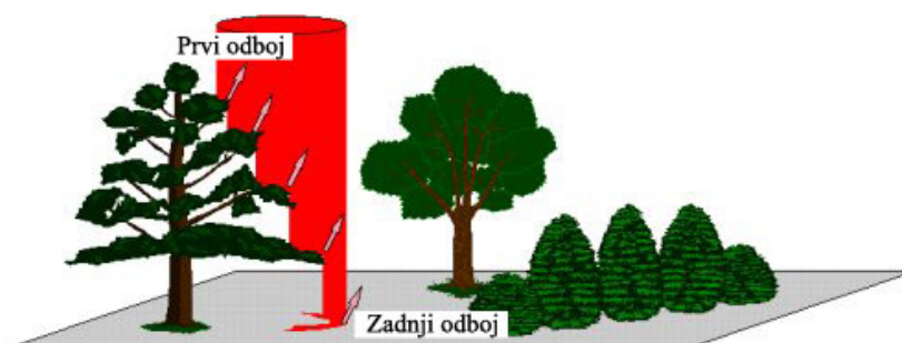
Slika 2-9: Več odbojev enega laserskega žarka na drevesu [TopoSys].
