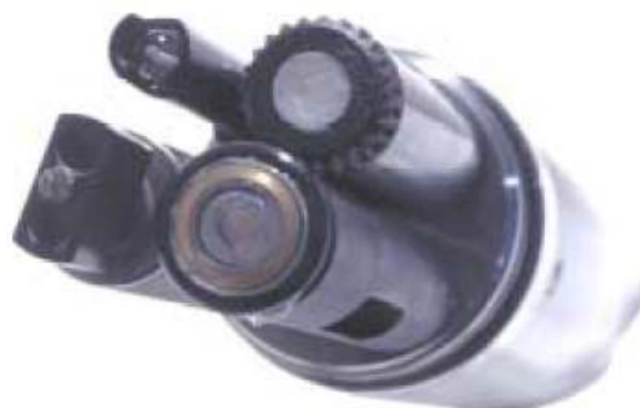
Slika 12: Pogled na spodnji del Minisonde – merilno glavo, z različnimi senzorji
