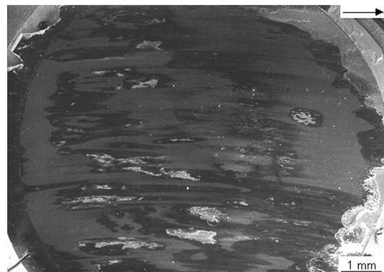
Figure VI.30 : Surface de frottement oxydée (essai 58 : 600°C, 1 m/s, 360 N)
