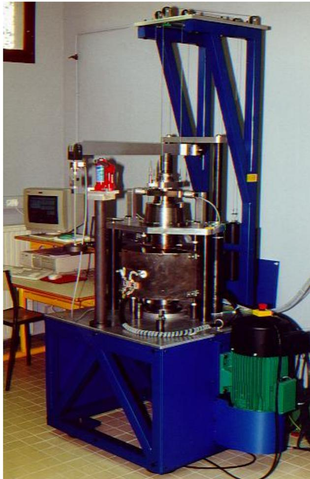
*Figure II.2 : Vue générale du tribomètre haute température.*
