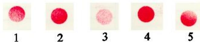
Figure III.5 : Empreinte visualisant la répartition des pressions dans un contact statique, pour différents couples d'échantillons. 1,  $Al_2O_3-Al_2O_3$  ; 2, 3 et 4  $WC.Co-WC.Co$  ; 5,  $WC.Co-Al_2O_3$ .
