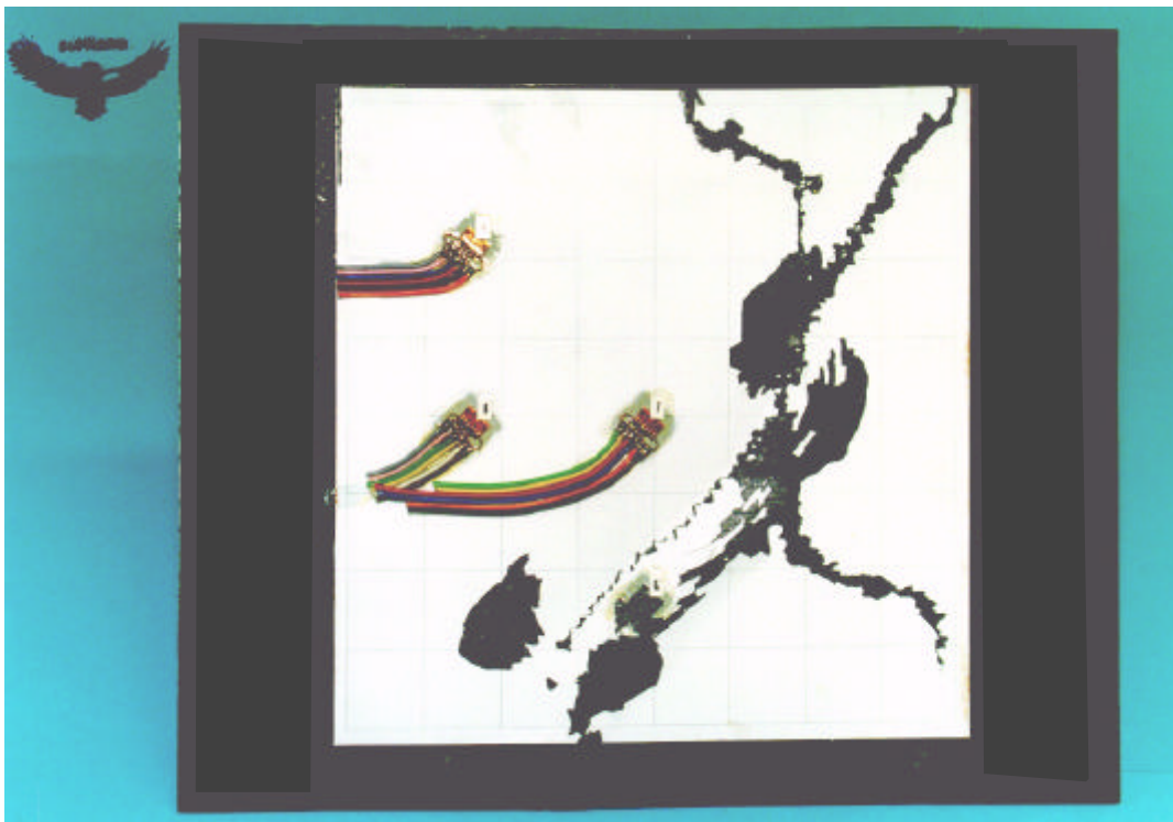
Photo N° A2-13 : Rupture sous sollicitations combinées éprouvette n°2
