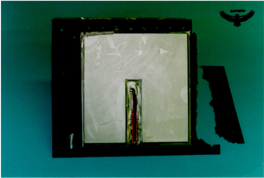
Photo N° A2-10 : Rupture dans la zone monolithique de la première éprouvette en cisaillement.
