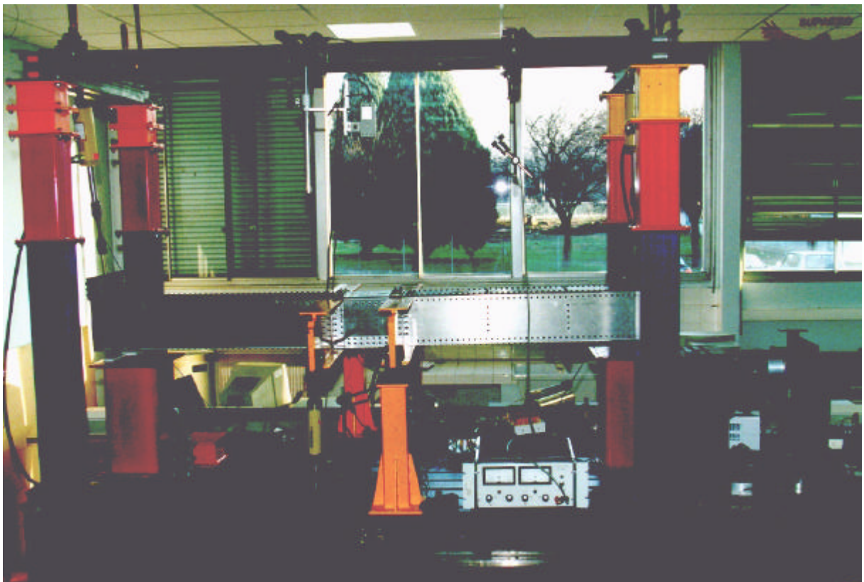
Photo N° A2-7 : Montage d'essai avec grille de Moiré
