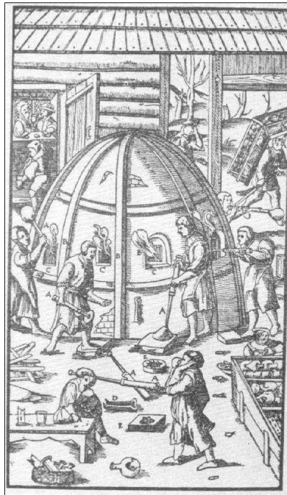
Figura 92 G. BAUER DETTO AGRICOLA, De re metallica , fornace per la raffinazione dei metalli.
