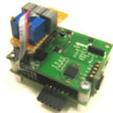
Şekil 8: Alçak-geçirgen filtre eklenmiş IMU.
