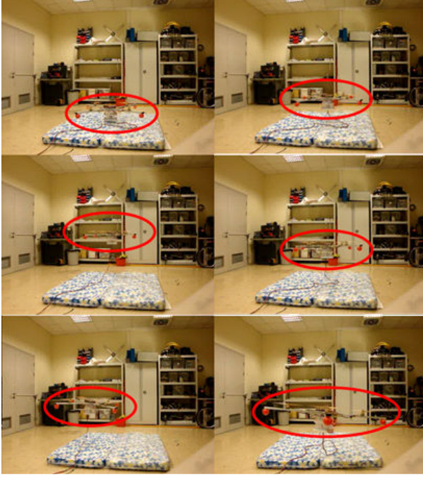
Şekil 17: Dört-rotorlu platformun dikey uçuş testi.
