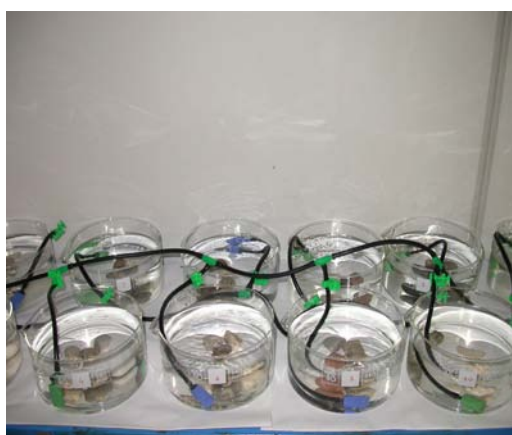
Fig.5: Cristallizzatori con aeratori per l'ossigenazione dell'acqua
