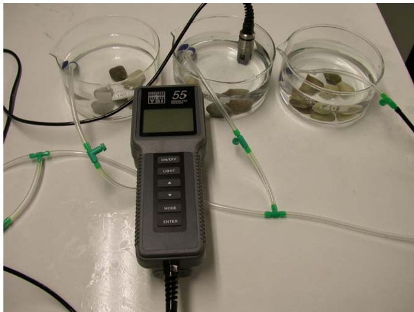
Fig.8: Ossimetro posizionato per stimare l'ossigeno disciolto
