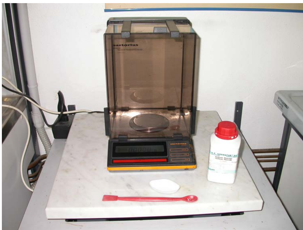
Fig.6: Bilancia analitica, usata per misurare la quantità di NaF
