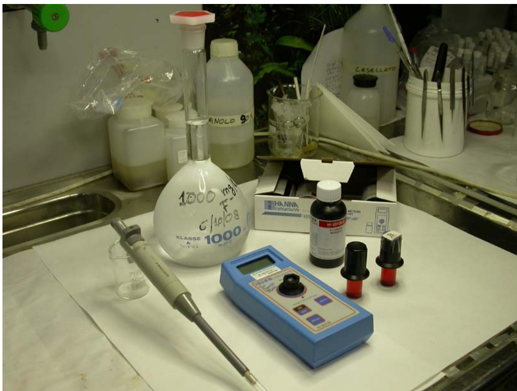
Fig.9: Misuratore della concentrazione di ioni F^- , micropipetta, Fluoride reagent, cuvette, pinzette, provette; soluzione di F^- da aggiungere a cristallizzatori
