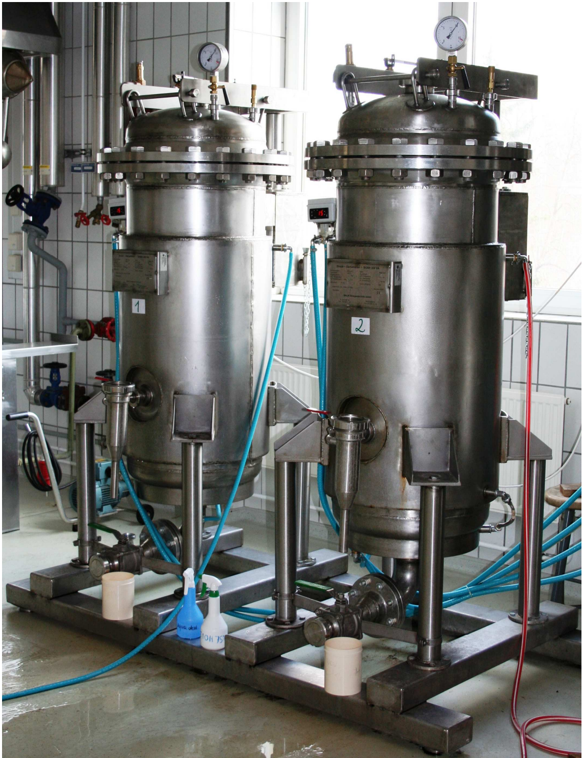
Abbildung 12: Drucktank 1 und 2 mit Manometer und Temperaturkontrolle
