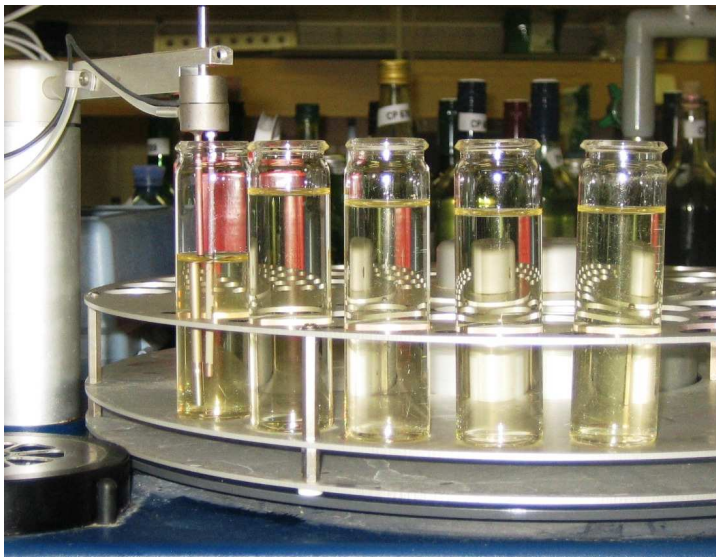
Abbildung 21: Platzierung der Proben am Probenteller und Aufsaugen der Probenflüssigkeit
