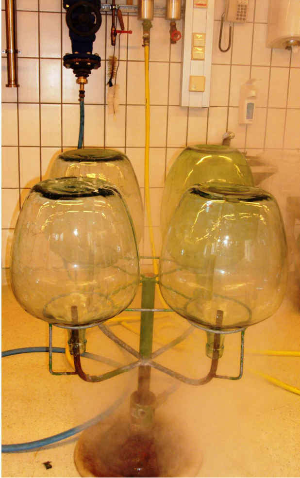
Abbildung 10: Dämpfen der Glasballons am Ballonwärmer
