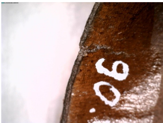
Abbildung 140: Schnittkante entlang des Randes (90.166/5), 30-fache Vergrößerung
