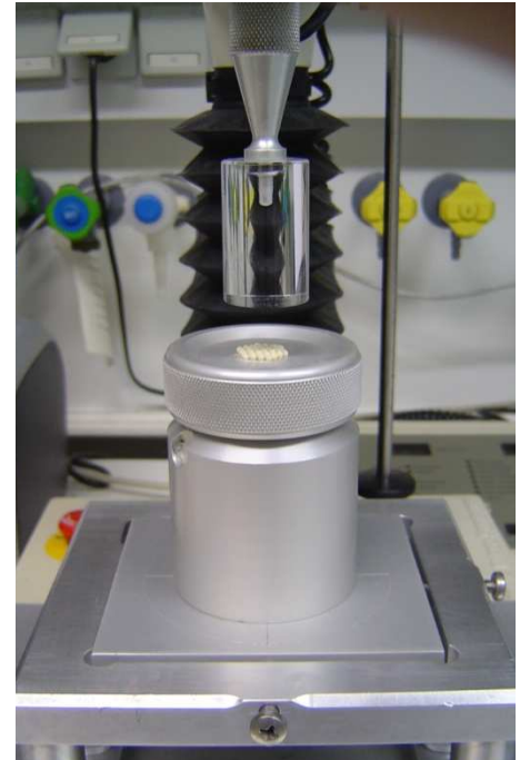
Abb. 16: SMS/Chen-Hoseney Teig-Klebrigkeits-Testvorrichtung im Gebrauch.
