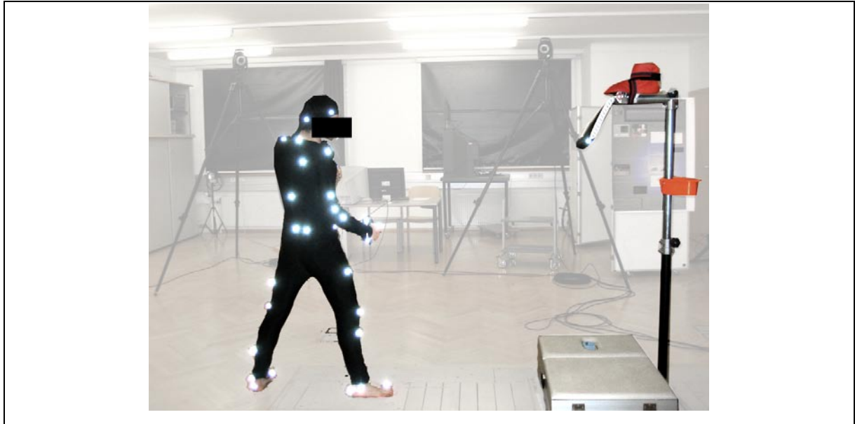
Abbildung 9 Versuchsaufbau: Proband mit Pratzenhalterung
