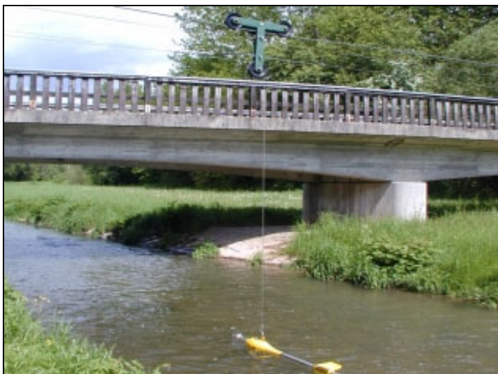
Abb. 14: Messung mit Schwimmflügel 56
