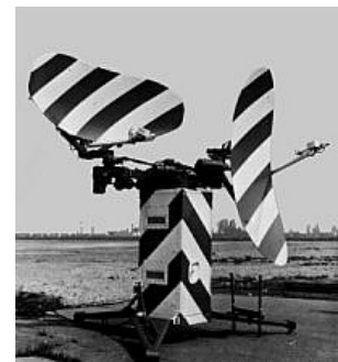
Abbildung 106: Radarantennen eines PAR.
