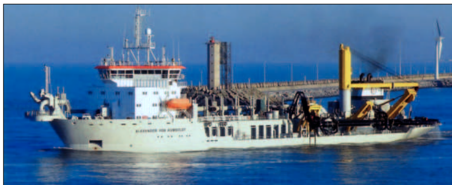
Fig. 3. Draga oceánica hasta 70 metros de profundidad de dragado, descarga por fondo y proa.
