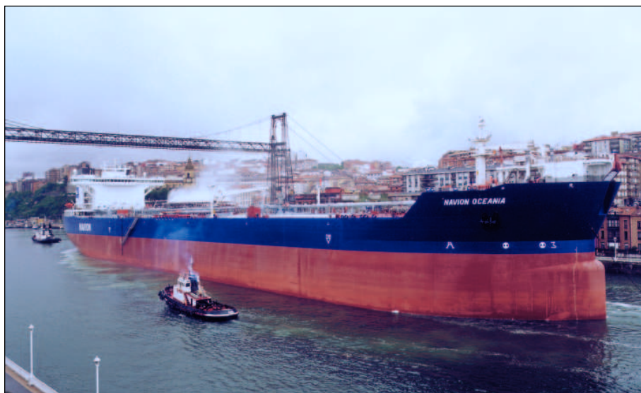
Fig. 1. Buque Shuttle con posicionamiento dinámico y toma de crudo submarina y de superficie en proa, para el Mar del Norte noruego.
