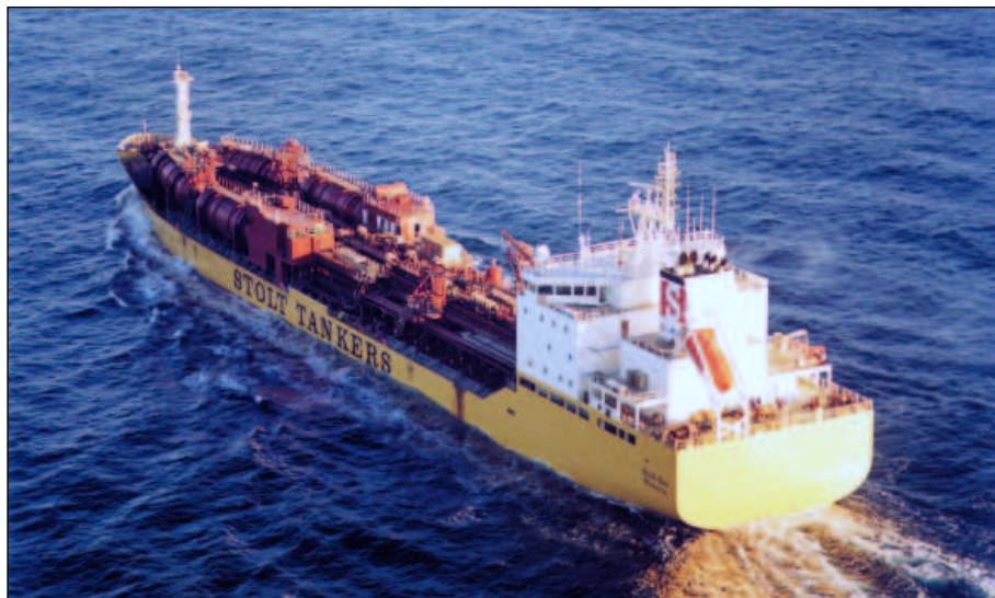
Fig. 2. Buque especial para el transporte de productos químicos corrosivos con 40 segregaciones independientes y sistemas de carga y descarga especiales, para tráfico mundial (cliente USA).
