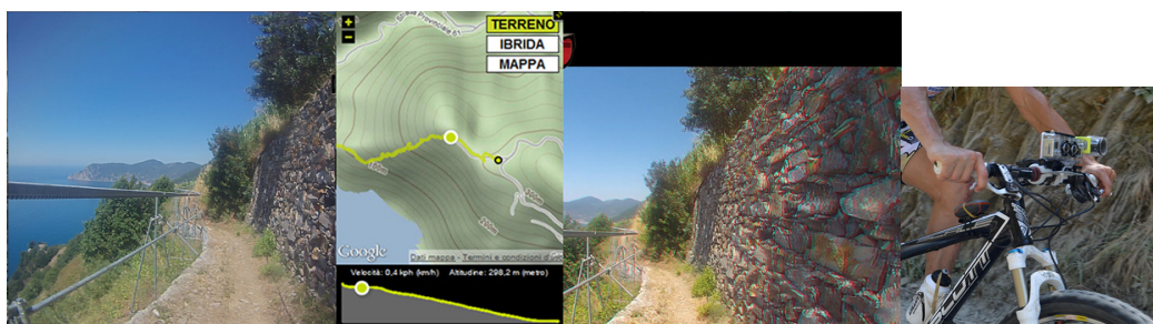
Figura 6. Esempio di coppia di immagini tratte da video 3D e relativa localizzazione geografica. Il manubrio di una mountain bike equipaggiato con il sistema stereo 3D go-pro e ricevitore GPS.
