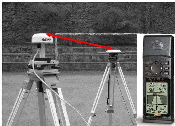
Figura 17. ricevitore e antenna GARMIN con adattatore e determinazione della posizione del centro di fase
