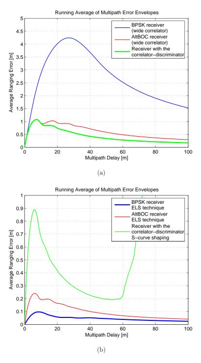
Figura 14: Prestazioni in presenza di cammini multipli ottenute con le tre architetture dei ricevitori: il ricevitore BPSK (30 MHz), il ricevitore AltBOC (51.150 MHz) ed il ricevitore con il correlatore-discriminatore (51.150 MHz). Confronto tra le prestazioni ottenute dai tre ricevitori senza tecniche di mitigazione dei cammini multipli (a) ed usando la migliore tecnica per ogni ricevitore (b)
