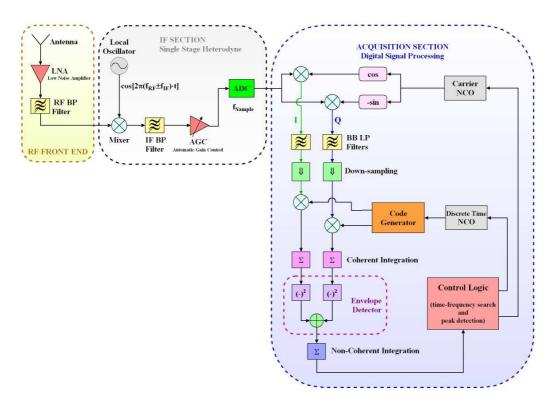
Figura 10: Schema di funzionamento della sezione di acquisizione per un ricevitore AltBOC (a banda singola)
