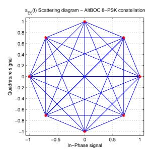
Figura 4: Diagramma scattering del segnale E5 AltBOC(15,10)
