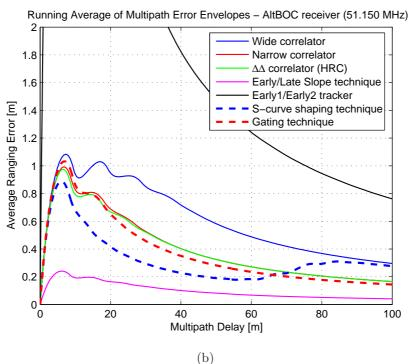
Figura 12: Confronto delle prestazioni in presenza di cammini multipli, usando le varie tecniche di mitigazione (tecniche comuni ed emergenti) per il ricevitore BPSK con una banda di 30 MHz (a) e per il ricevitore AltBOC con una banda di 51.150 MHz (b)
