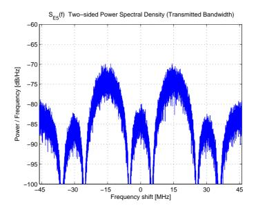
Figura 3: Spettro di frequenza del segnale E5 AltBOC(15,10)
