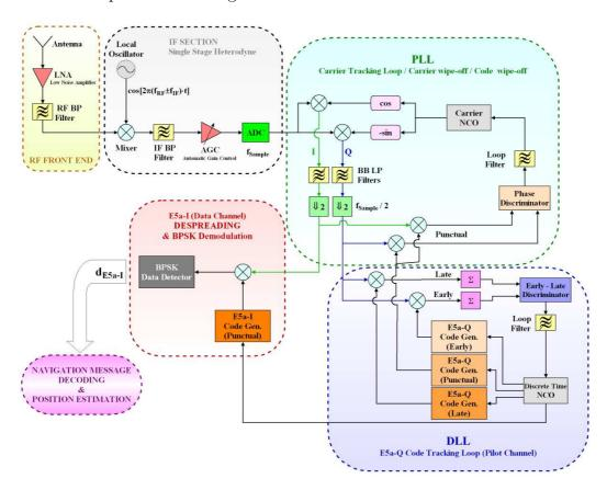
Figura 6: Schema a blocchi dell'architettura di un ricevitore a banda singola
