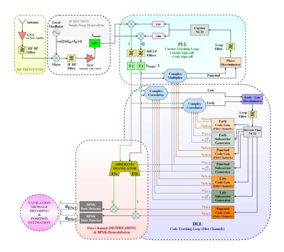
Figura 8: Schema a blocchi del ricevitore coerente a due bande
