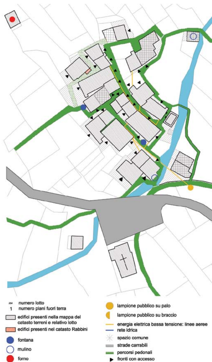
[Fig. 12 - accessibilità e dotazione di servizi - scala 1:1000]
