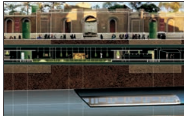
Sezione su via dei Fori Imperiali con l'ipotesi di museo archeologico ipogeo che raccoglie i materiali ritrovati durante gli scavi
