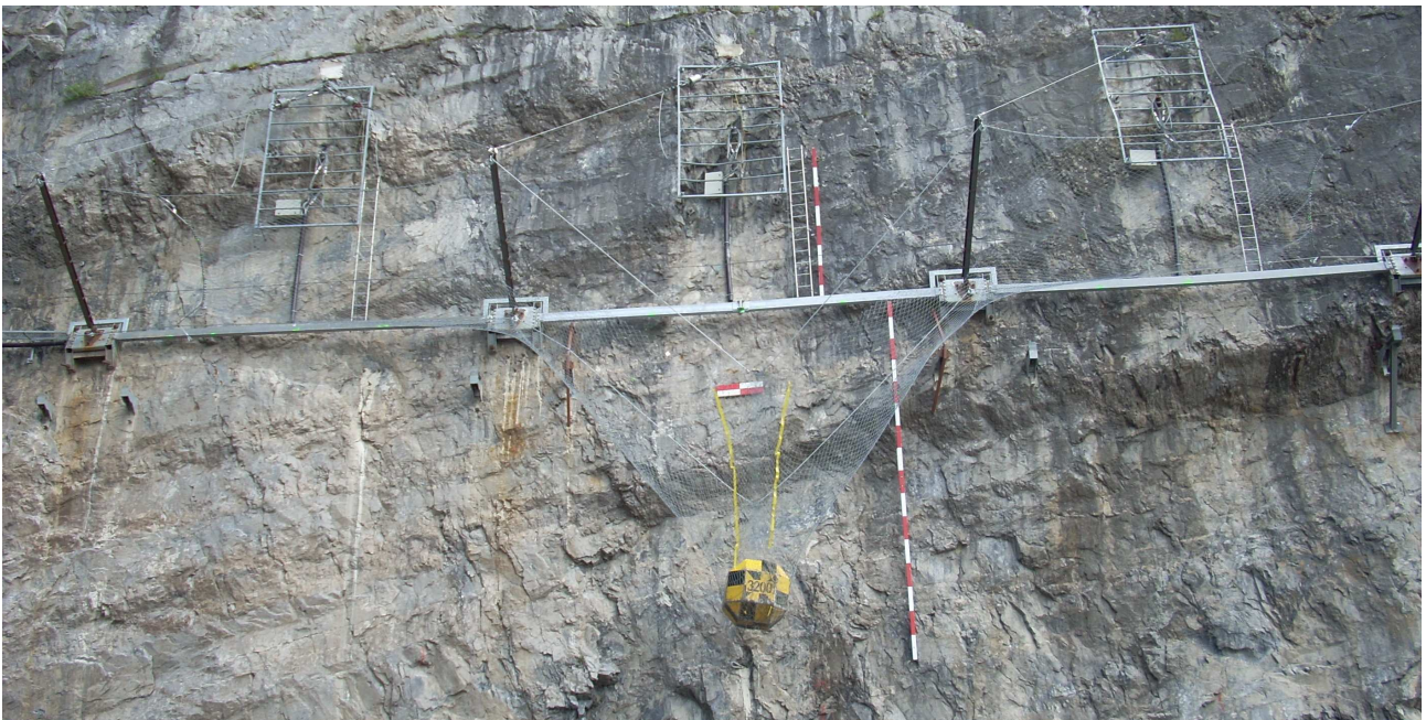
Fig. 2-b Fotografia di una barriera sottoposta a prova con il blocco intrappolato dalla rete come risultante da un prova a caduta verticale
