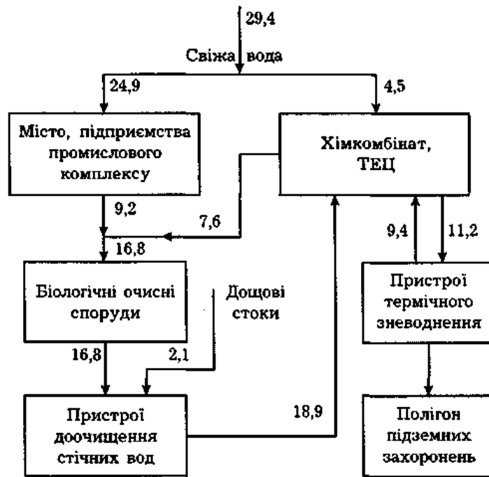
Рис. 13.4 – Комплексна схема і баланс споживання води з використанням стічних вод хімічного комбінату, ТЕЦ, міста та підприємств промислового комплексу (цифри – витрата води в тис. m^3/добу з вирахуванням безповоротних втрат)
