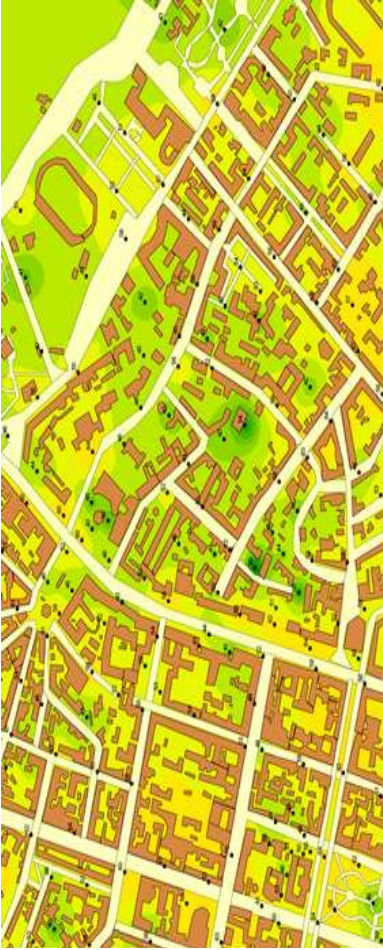
Рис. 4.48 – Карта шуму того ж району ( L , дБ в октавній смузі частот f = 250 Гц)
