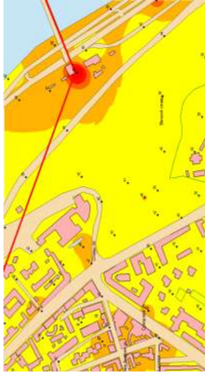
Рис. 4.40 - Карта шуму. Побудовано за значеннями рівнів звукового тиску у октавній смузі із середньгеометричною частотою 2000 Гц у в контрольних точках, дБ. Нормативний рівень звукового тиску у октавній смузі із середньгеометричною частотою 2000 Гц L_{2000} = 32 дБ
