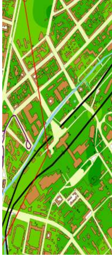
Рис. 3.47 – Карта шуму того ж району (побудовано по показнику: рівень звукового тиску, дБ в октавній смузі частот зі середньогометричною частотою 31,5 Гц)
