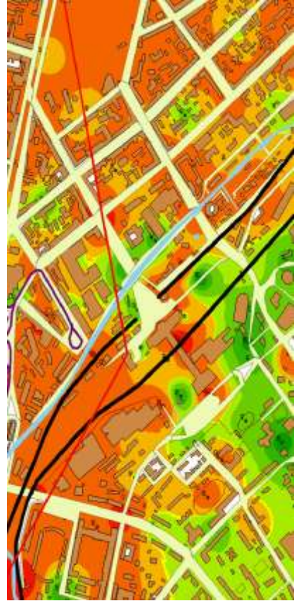
Рис. 3.55 – Карта шуму того ж району (побудовано по показнику: рівень звукового тиску, дБ в октавній смузі частот зі середньгеометричною частотою 8000 Гц)
