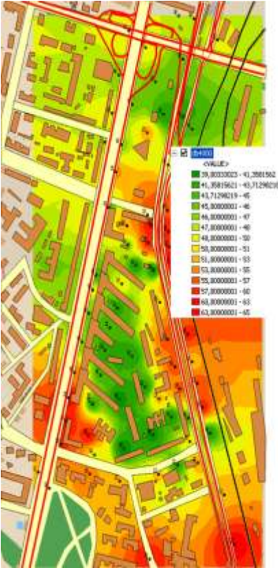
Рис. 4.14 – Карта шуму. Побудовано за значеннями рівнів звукового тиску у октавній смузі із середньогогеометричною частотою 4000 Гц у в контрольних точках, дБА. Нормативний рівень L_{4000} = 50 дБ
