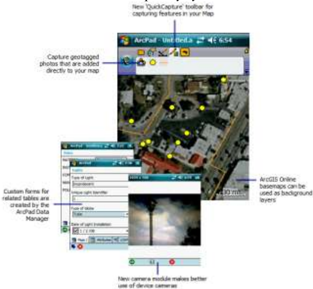
Рис. 3.14 – Нативна ілюстрація з довідки програми ArcPad 10 з ілюстрацією її можливостей (від авторів програми). Далі ми покажемо застосування цих функцій до нашого випадку вимірів шуму й картографування шумового режиму
