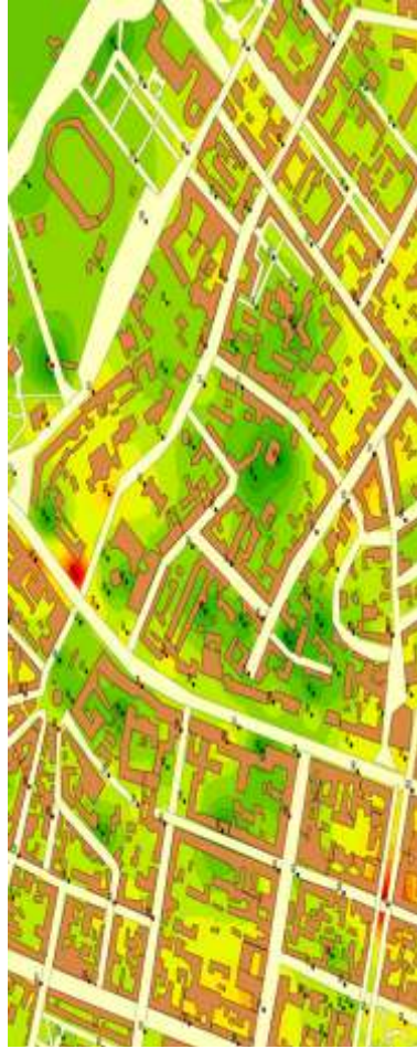
Рис. 4.49 – Карта шуму того ж району ( L , дБ в октавній смузі частот f = 500 Гц)
