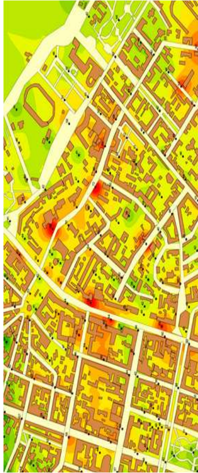
Рис. 4.53 – Карта шуму того ж району ( L , дБ в октавній смузі частот f = 8000 Гц)
