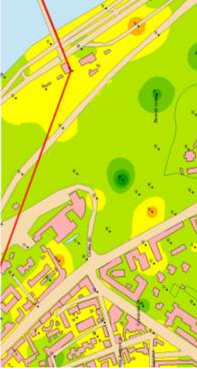
Рис. 4.37 - Карта шуму. Побудовано за значеннями рівнів звукового тиску у октавній смузі із середньгеометричною час- тототою 250 Гц у в контрольних точках, дБА. Нормативний рівень звукового тиску у октавній смузі із середньгео- метричною частотою 250 Гц L_{250} = 45 дБ
