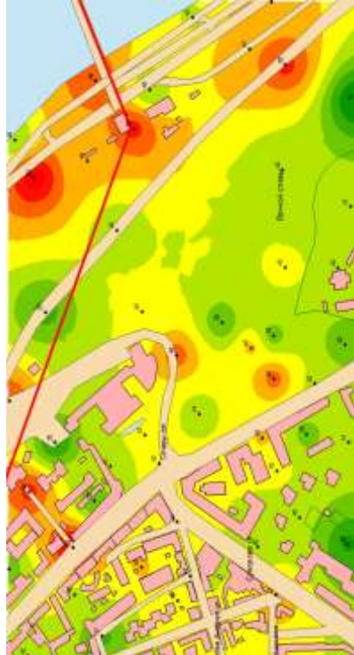
Рис. 4.38 - Карта шуму. Побудовано за значеннями рівнів звукового тиску у октавній смузі із середньгеометричною час- тототою 500 Гц у в контрольних точках, дБ. Нормативний рівень звукового тиску у октавній смузі із середньгеометричною час- тототою 500 Гц L_{500} = 39 дБ
