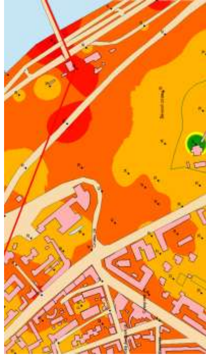
Рис. 4.42 - Карта шуму. Побудовано за значеннями рівнів звукового тиску у октавній смузі із середнього- метричною частотою 8000 Гц у в контрольних точках, дБА. Нормативний рівень звукового тиску у октавній смузі із се- редньогометричною частотою 8000 Гц L_{8000} = 28 дБ
