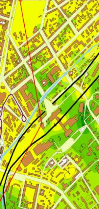
Рис. 3.50 – Карта шуму того ж району (побудовано по показнику: рівень звукового тиску, дБ в октавній смузі частот зі середньгеометричною частотою 250 Гц)
