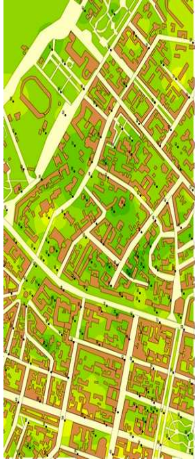
Рис. 4.47 – Карта шуму того ж району ( L , дБ в октавній смузі частот f = 125 Гц)
