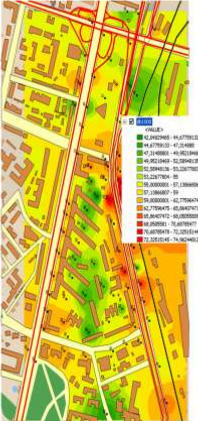
Рис. 4.12 – Карта шуму. Побудовано за значеннями рівнів звукового тиску у октавній смузі із середньгео- метричною частотою 1000 Гц у в контрольних точках, дБ. Нормативний рівень L_{1000} = 55 дБ
