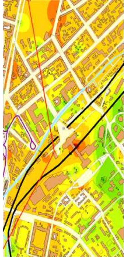
Рис. 3.53 – Карта шуму того ж району (побудовано по показнику: рівень звукового тиску, дБ в октавній смузі частот зі середньгеометричною частотою 2000 Гц)
