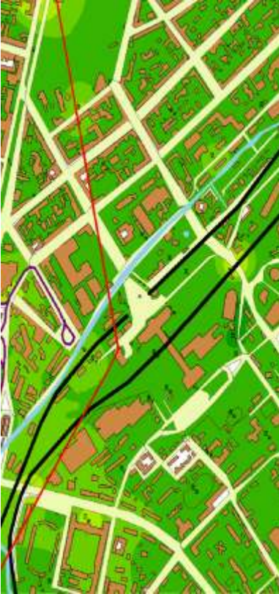
Рис. 3.48 – Карта шуму того ж району (побудовано по показнику: рівень звукового тиску, дБ в октавній смузі частот зі середньгеометричною частотою 63 Гц)
