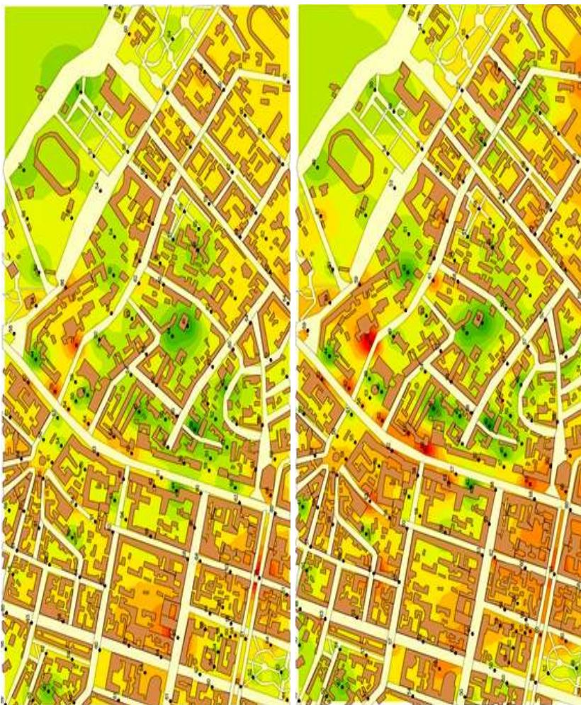
Рис. 4.50 – Карта шуму того ж району ( L , дБ в октавній смузі частот f = 1000 Гц)
