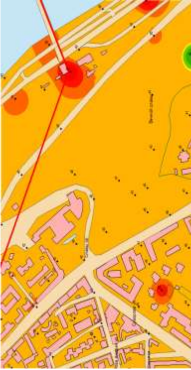
Рис. 4.39 - Карта шуму. Побудовано за значеннями рівнів звукового тиску у октавній смузі із середньгеометричною частотою 1000 Гц у в контрольних точках, дБ. Нормативний рівень звукового тиску у октавній смузі із середньгеометричною частотою 1000 Гц L_{1000} = 35 дБ
