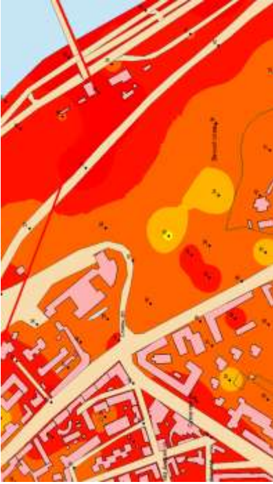
Рис. 4.41 - Карта шуму. Побудовано за значеннями рівнів звукового тиску у октавній смузі із середньогометричною час- тотою 4000 Гц у в контрольних точках, дБА. Нормативний рівень звукового тиску у октавній смузі із середнього- метричною частотою 4000 Гц L_{4000} = 30 дБ
