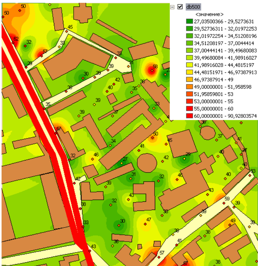
Рис. 4.24 - Карта шуму. Побудовано за значеннями рівнів звукового тиску у октавній смузі із середньгеометричною частотою 500 Гц в контрольних точках, дБ. Нормативний рівень звукового тиску у октавній смузі із середньгеометричною частотою 500 Гц L_{500} = 39 дБ
