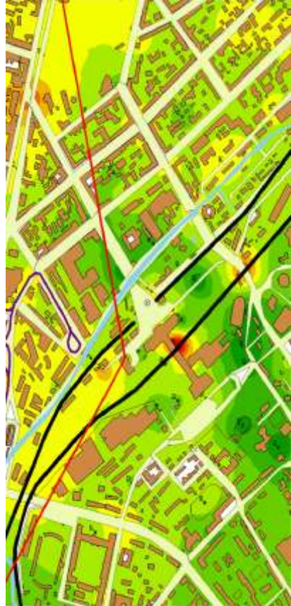
Рис. 3.51 – Карта шуму того ж району (побудовано по показнику: рівень звукового тиску, дБ в октавній смузі частот зі середньгеометричною частотою 500 Гц)
