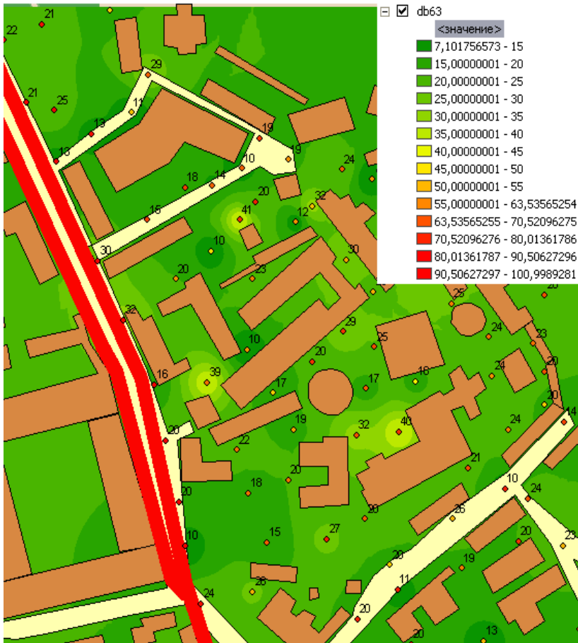
Рис. 4.21 - Карта шуму. Побудовано за значеннями рівнів звукового тиску у октавній смузі із середньо геометричною частотою 63 Гц у в контрольних точках, дБ. Нормативний рівень звукового тиску у октавній смузі із середньо геометричною частотою 63 Гц L_{63} = 63 дБ
