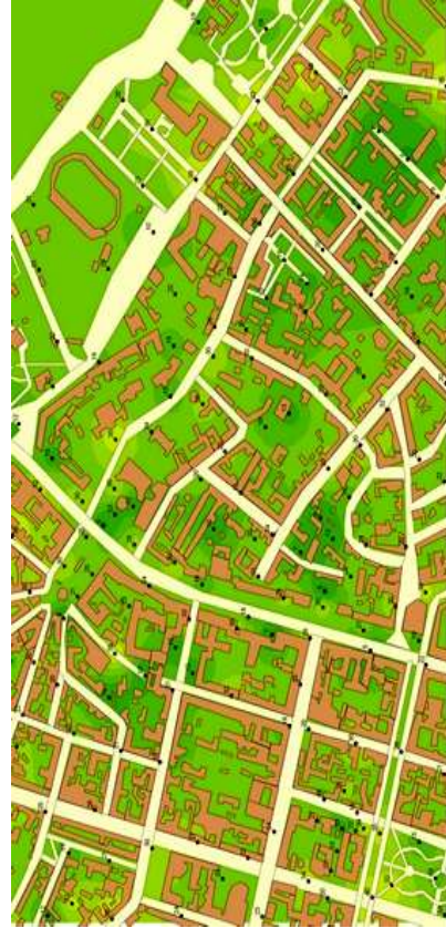
Рис. 4.45 – Карта шуму того ж району ( L , дБ в октавній смузі частот f = 31,5 Гц)
