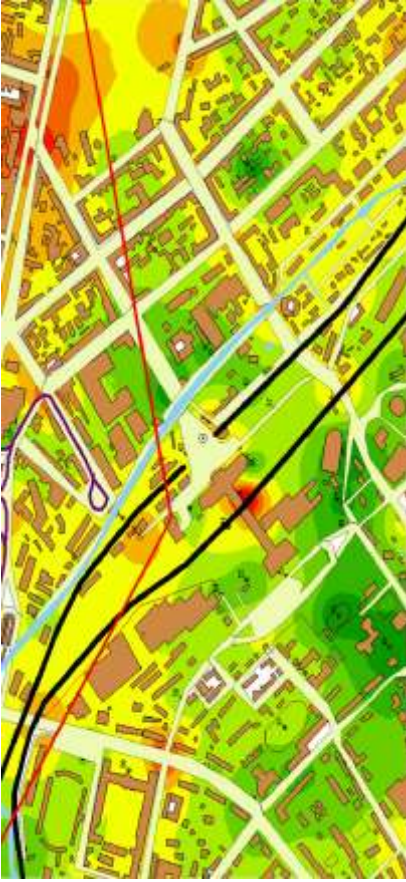
Рис. 3.52 – Карта шуму того ж району (побудовано по показнику: рівень звукового тиску, дБ в октавній смузі частот зі середньгеометричною частотою 1000 Гц)
