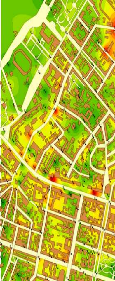
Рис. 4.52 – Карта шуму того ж району ( L , дБ в октавній смузі частот f = 4000 Гц)
