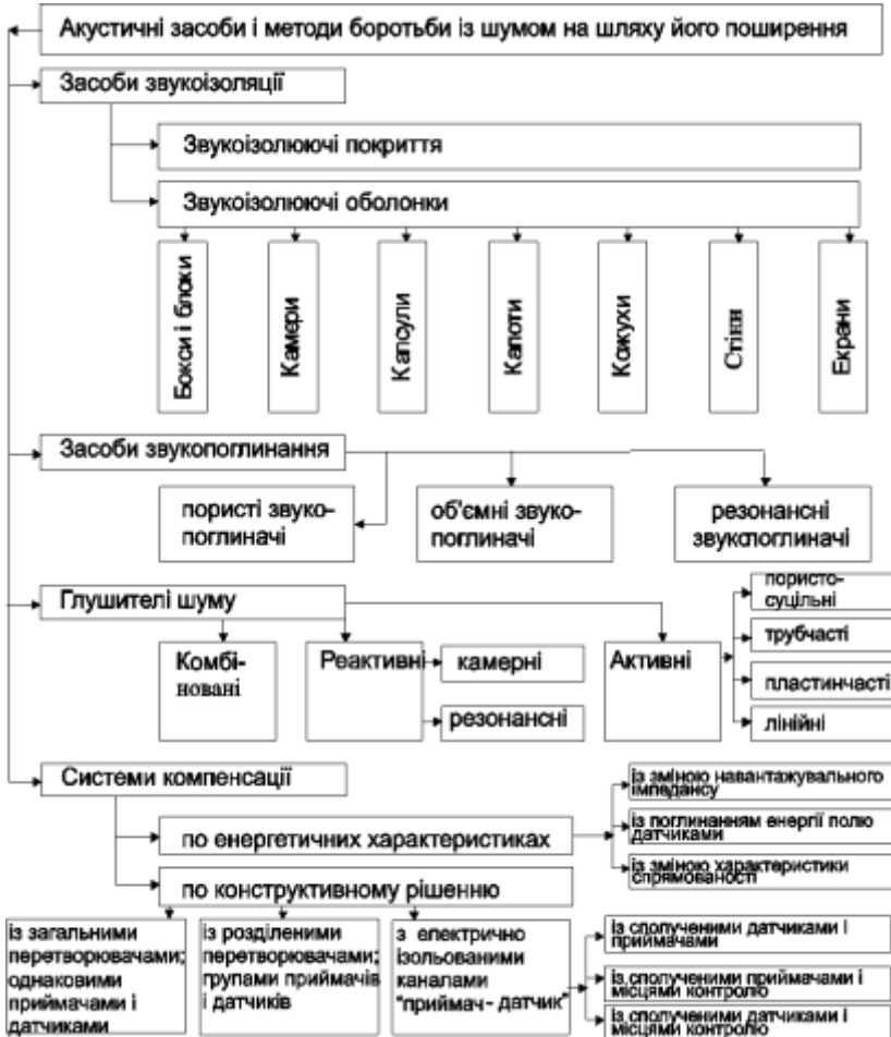
Рис. 5.18 - Класифікація акустичних засобів колективного захисту від шуму на шляху його поширення залежно від способу реалізації відповідно до класифікації ГОСТ 12.1.029-80
