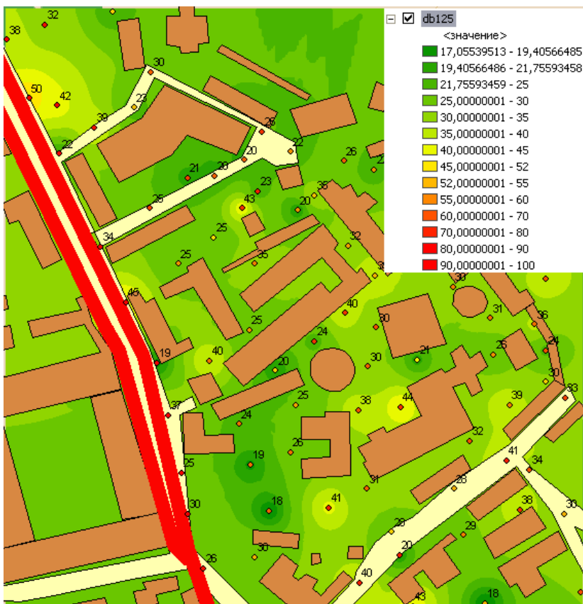
Рис. 4.22 - Карта шуму. Побудовано за значеннями рівнів звукового тиску у октавній смузі із середньгеометричною частотою 125 Гц у контрольних точках, дБ. Нормативний рівень звукового тиску у октавній смузі із середньгеометричною частотою 125 Гц L_{125} = 52 дБ
