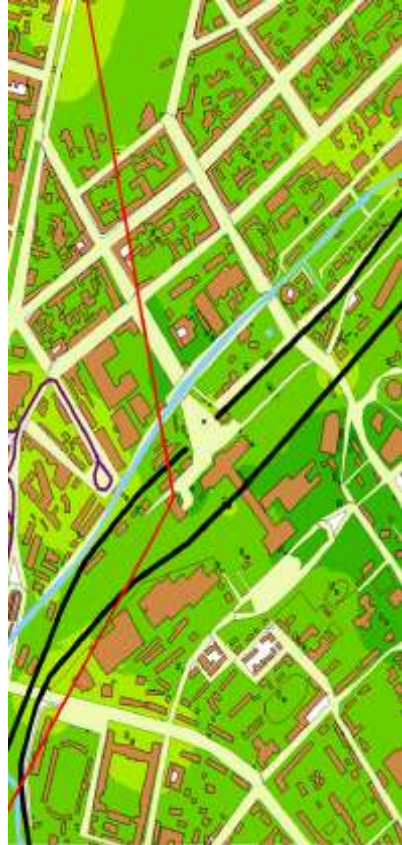
Рис. 3.49 – Карта шуму того ж району (побудовано по показнику: рівень звукового тиску, дБ в октавній смузі частот зі середньгеометричною частотою 125 Гц)
