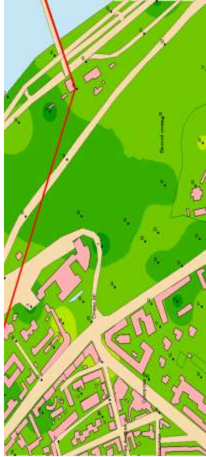
Рис. 4.34 - Карта шуму. Побудовано за значеннями рівнів звукового тиску у октавній смузі із середньогометричною частотою 31,5 Гц у в контрольних точках, дБ
