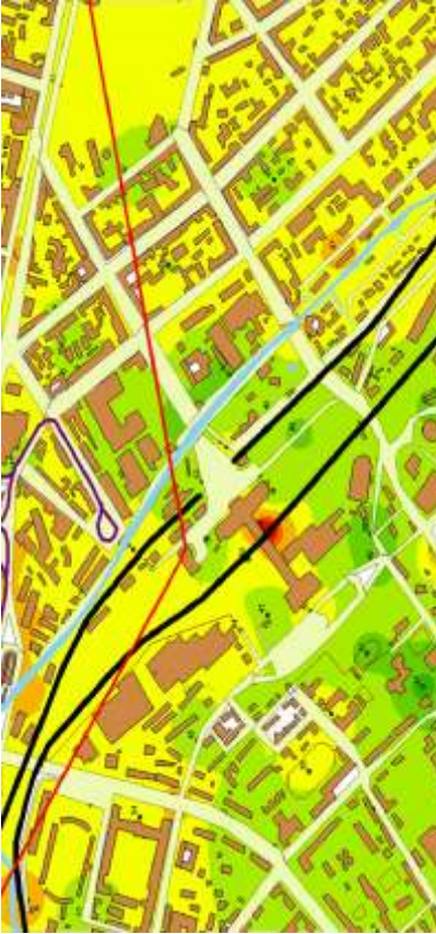
Рис. 3.54 – Карта шуму того ж району (побудовано по показнику: рівень звукового тиску, дБ в октавній смузі частот зі середньгеометричною частотою 4000 Гц)
