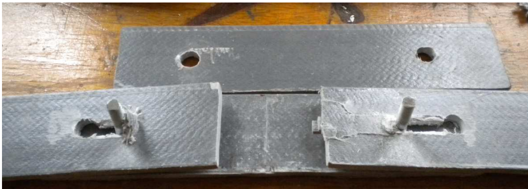
Рис. 8 – Характер руйнування болтового з'єднання
