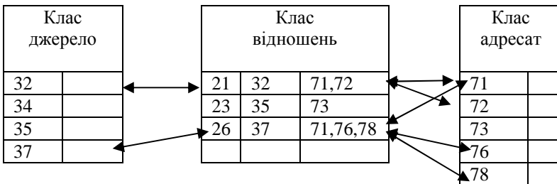
Рис. 4.3.1 – Клас відношень "один-до-багатьох" в базі геоданих
