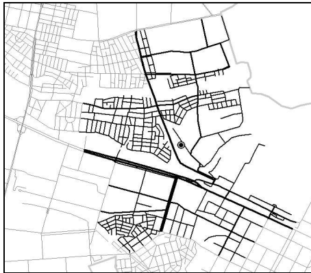
Рис. 5.7.5 - Мережа обслуговування доріг, видалених по реальних шляхах до 3,5 км. від одного дорожно-експлуатаційного управління
