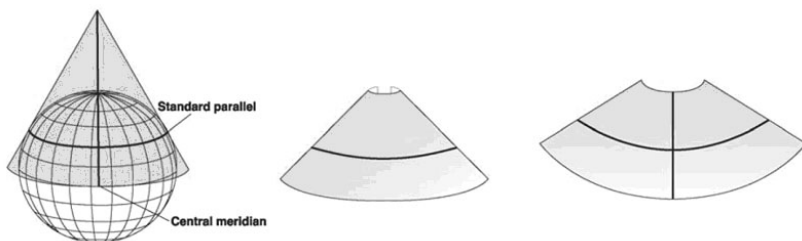
Рис. 3.3.9 - Дотична конічна проекція [43]
