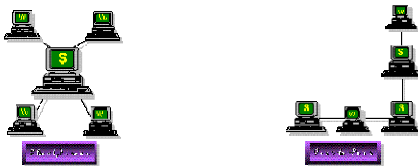
Рис. 1.12. - Сервер-клиент в сети при соединении "звезда" и "цепь"
