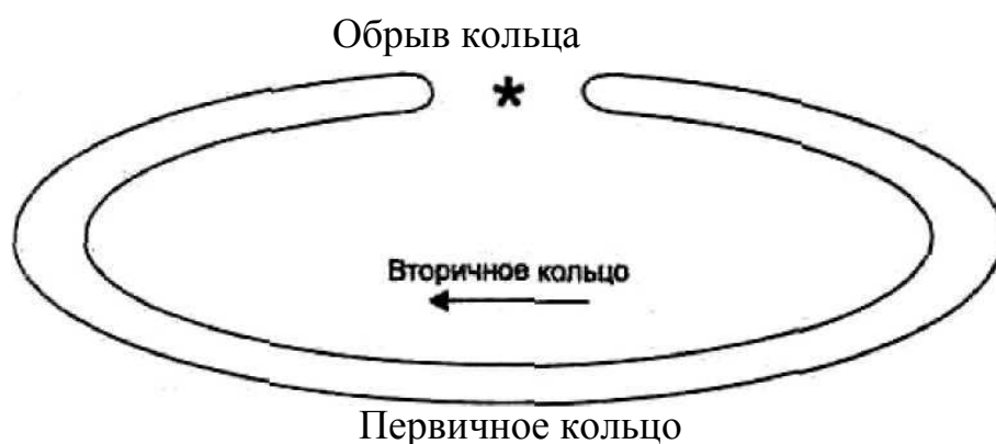
Рис.2.3 - Восстановление работоспособности сети FDDI при обрыве кольца.
