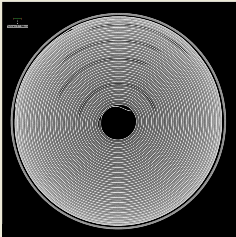
Abbildung 2.11 – CT-Bild der Aufsicht auf den Akkumulator. Gut erkennbar hier ist die Anzahl der Wiederholeinheiten und das Auslaufen der Wicklungen ganz innen und ganz außen. Die dunkelgrauen Teilkreise innerhalb der Wiederholeinheiten sind die Stromleiter zu den Polen des Akkumulators. [5]
