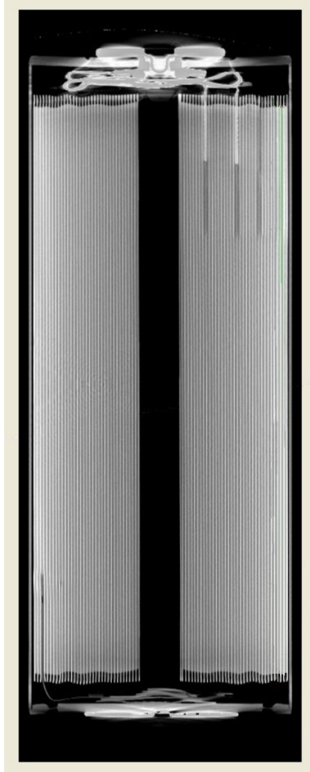
Abbildung 2.12 – CT-Aufnahme des kompletten Querschnitts. Gut erkennbar sind hier die Relationen zu genutzten Wiederholeinheiten, Stromabnehmern und verlorenem Hohlraum. [5]
