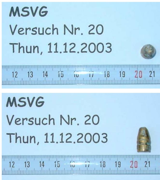
Abbildung 34 a+b: Nahezu formstabilen MsVG nach Beschuss unter einem Schusswinkel von 90 Grad
