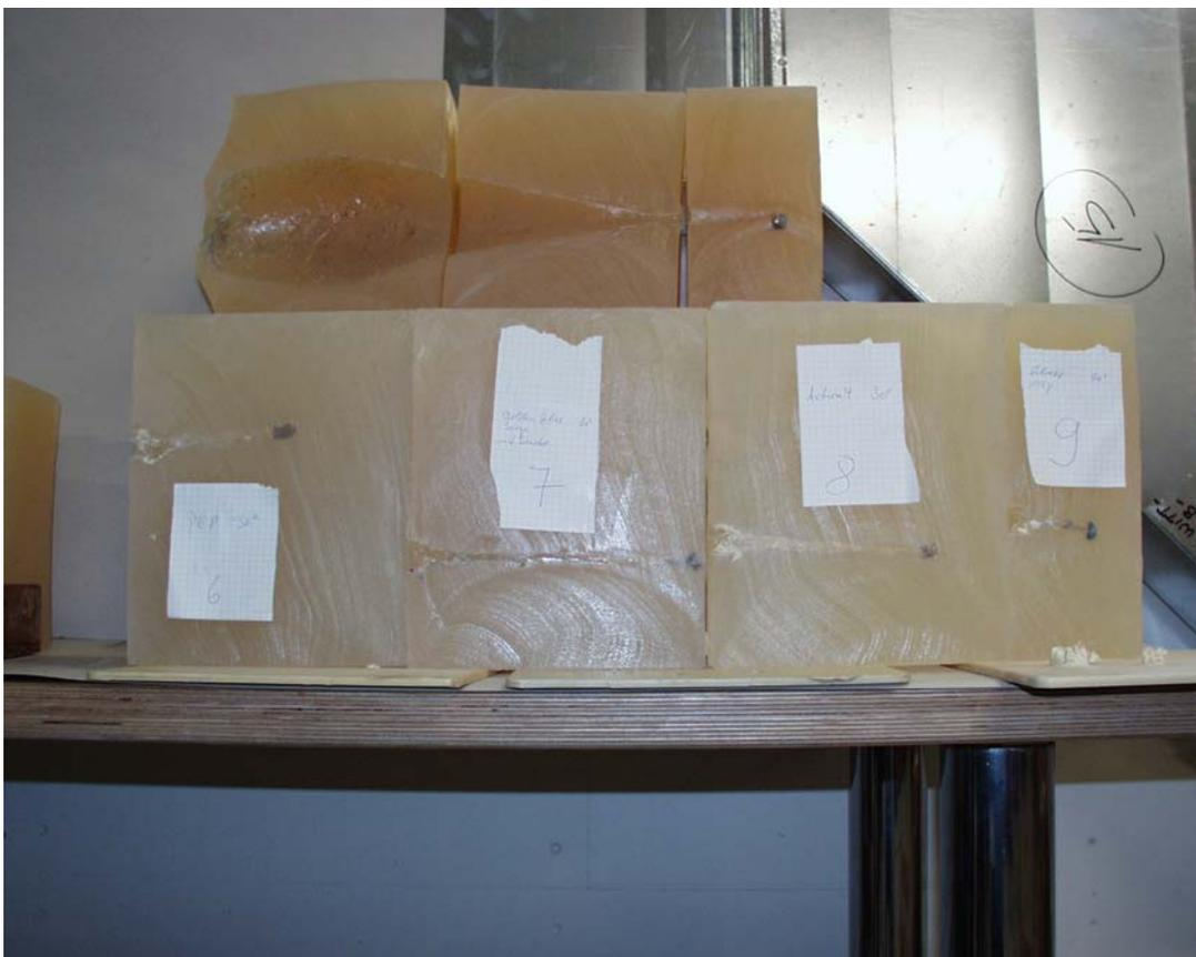
Abbildung 36 a+b: Querschnitte der beschossenen Seifenblöcke der Schüsse 1–9
