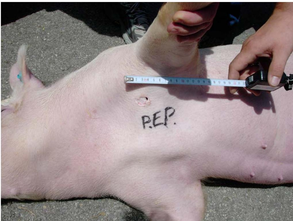
Abbildung 43: Einschussstelle nach Beschuss mit der P.E.P. unter einem Schusswinkel von 30 Grad, Schuss Nr. 6
