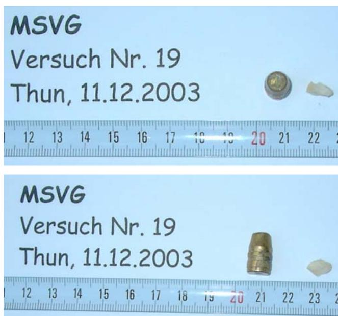
Abbildung 35 a+b: Nahezu formstabilen MsVG nach Beschuss unter einem Schusswinkel von 30 Grad
