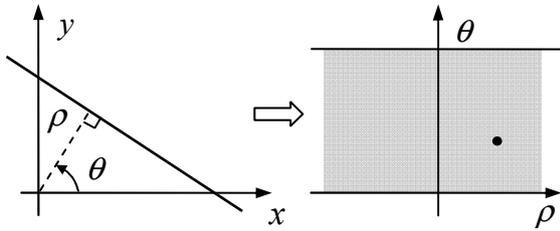
Figure 4 Mapping of a line to parameter space
