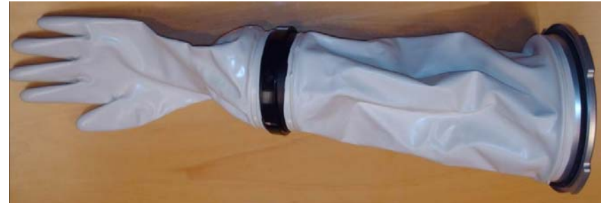
MSG Glove & Gauntlet Configuration (7 mil Hypalon Glove, 15 mil Gauntlet)
