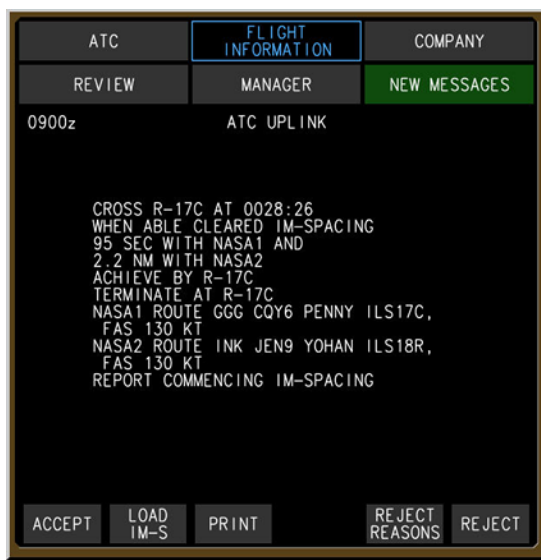
Figure 3. CPDLC IM clearance on EICAS.
