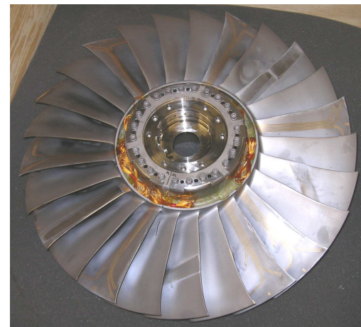
GE57 fan rig – fan blisk thin-film strain gages
