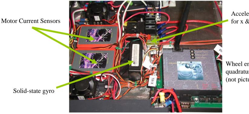
Accelerometer for x & y tilt
