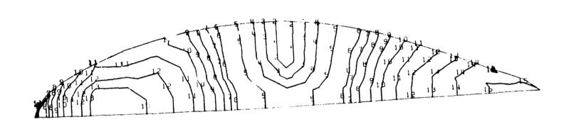
FIGURE 2. ANGLE OF INCIDENCE CONTOURS ON A RADOME SURFACE
